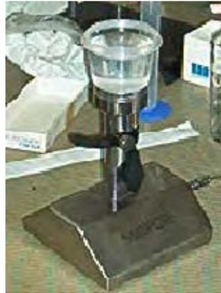
**FIGURA N° 4. EQUIPO DE FILTRACIÓN DE MEMBRANA MICROFILM DE MILLIPORE UTILIZADO PARA EL ANÁLISIS BACTERIOLÓGICO**
