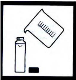
a) Se recogió una muestra representativa en un recipiente limpio. Se llenó una celda para muestras hasta la línea de llenado (15 mL), tomando la celda por la parte superior. Se cerró la celda para impedir el derrame de la muestra en el interior del instrumento.
