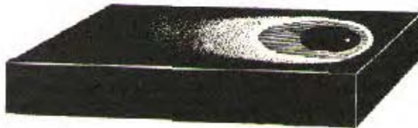
FIGURA N° 4. Bloque de carbón utilizado para los ensayos.
