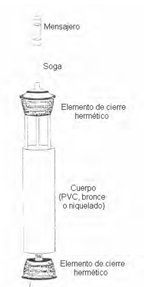
Figura 9. Extractor Kemmerer para muestras discretas
