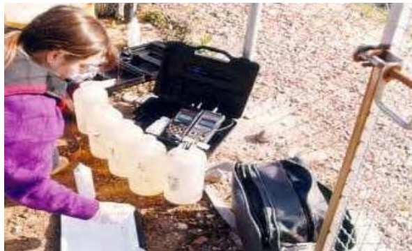
Figura 3. Medición de la conductividad y pH de las muestras.
