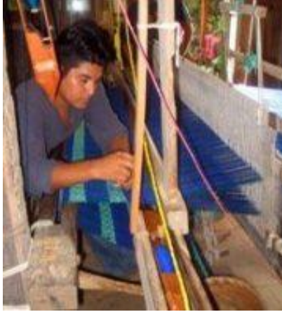
Plegado al telar de palanca para su trama (01-2010)
