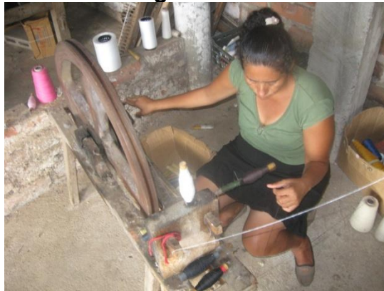
Torno de madera hilando hilo en cono para su tejido (2010)
