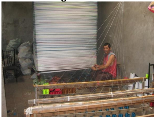
Urdimbre y trascañadera de madera con su hilo de sedalina (nov.2009)
