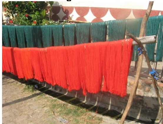
Secado al sol de hilo de algodón en barras de bambú (10-2009)
