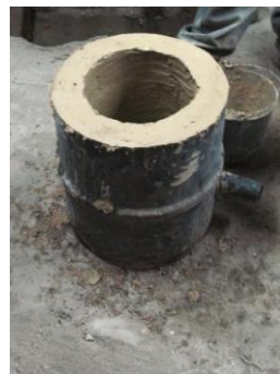
Figura 50 Paredes del horno con repello refractario.
