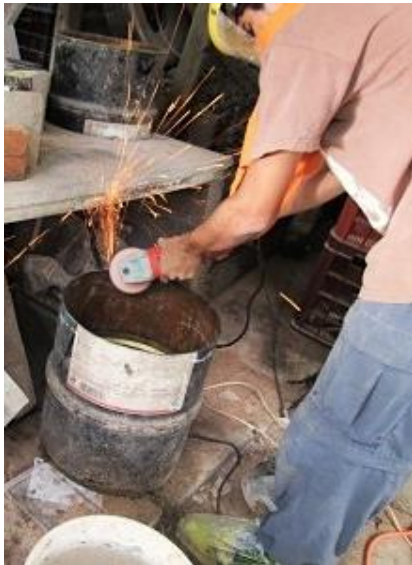
Figura 41 Devaste del filo del corte con disco de desbaste.
