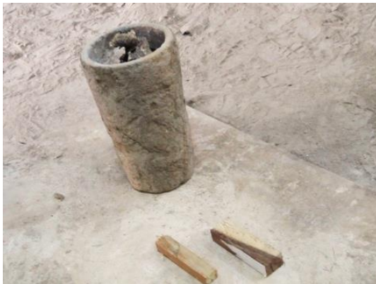
Figura 68 Crisol y bronce para la fundición.
