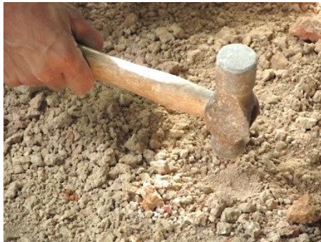
Figura 47 Preparación de chamote refractario.
