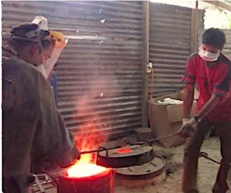
Figura 72 Operarios destapando el horno
