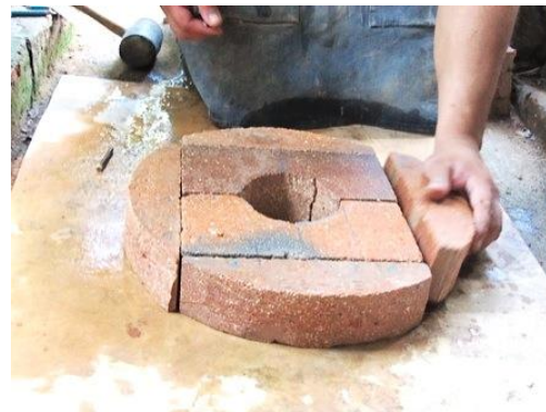
Figura 54 Comprobación de los ensambles
