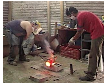
Figura 75 Operarios vaciando el metal
