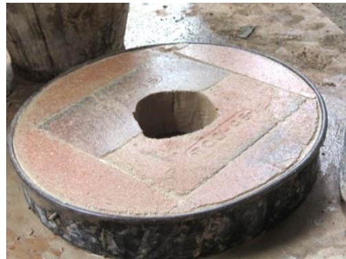
Figura 58 Tapadera de ladrillos refractarios finalizada.
