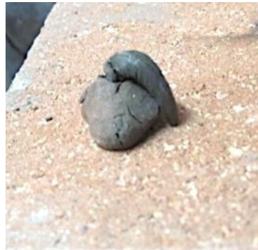
Figura 66 Cono pirométrico después de la quema
