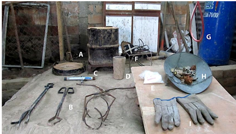
Figura 67 Equipo básico para la fundición de bronce
