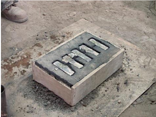
Figura 76 Lingotes dentro del molde de arena
