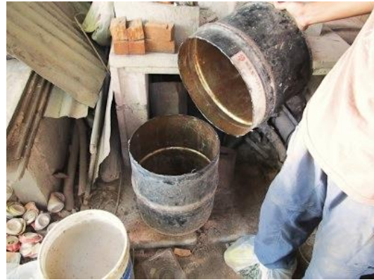
Figura 40 Sección del barril cortada a la altura del diseño.
