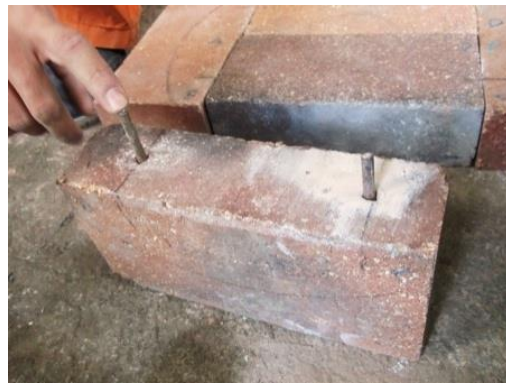
Figura 52 Ensamble de ladrillo con varilla de hierro
