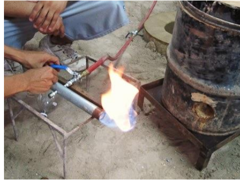
Figura 64 Encendido del sistema de combustión (prueba de quemador)
