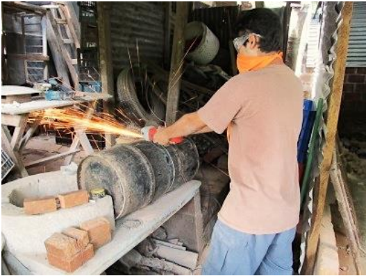
Figura 39 Corte de barril metálico con esmeril angular.
