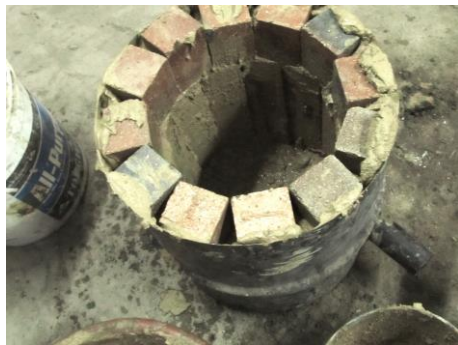
Figura 49 Pared completada al interior del revestimiento metálico.
