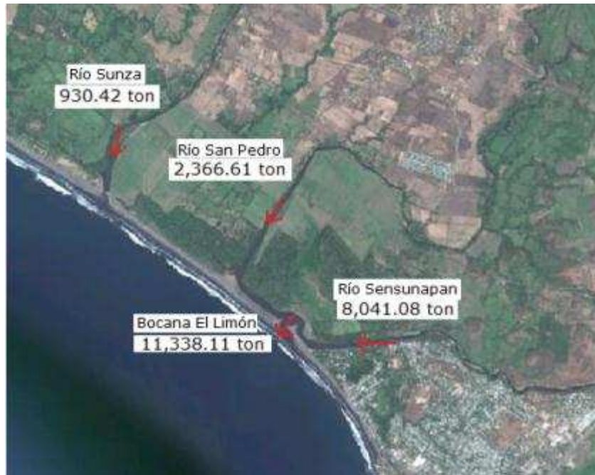
Figura 56. Cantidad de arenas finas que desembocan en la Bocana El Limón, producto de los procesos erosivos en los ríos Sensunapán, San Pedro y Sunza.
