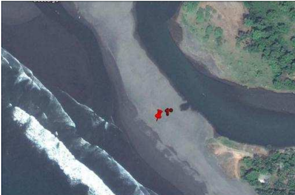
Figura 82. Punto de control propuesto para el cordón litoral en la Figura 80, ubicado en la parte más alta del talud de playa.
