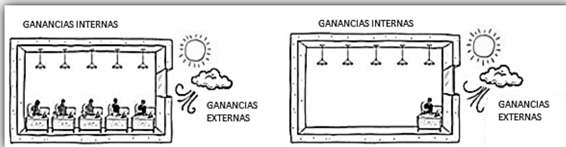
FIGURA 14 CARGAS INTERNAS Y EXTERNAS DE UN EDIFICIO.
