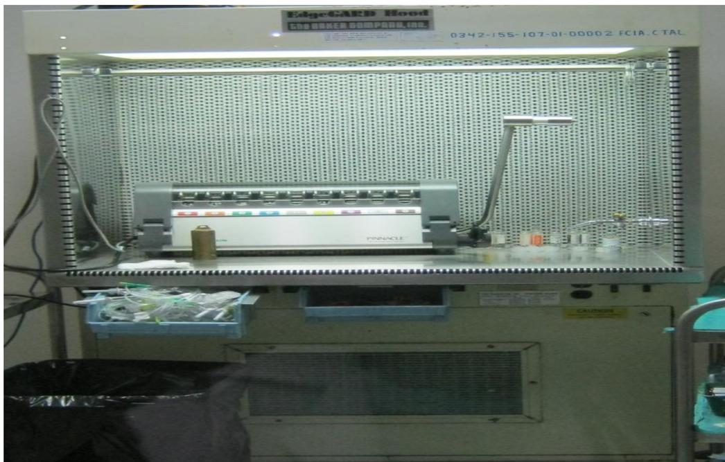
Figura N°11. Cámara de Flujo Laminar Horizontal del área de NP.
