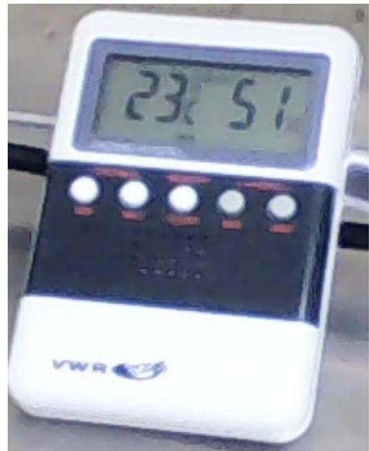
Figura N° 22. Termohigrometro vwr Modelo: 35519-047
