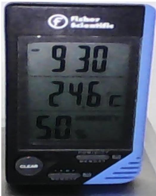
Figura N° 21. Termohigrometro Fisher Scientific Modelo:06-662-4
