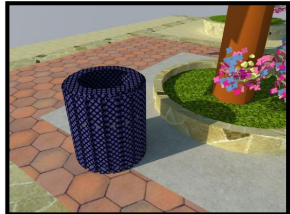
IMG.148 Diseño de basurero de lámina desplegada en forma de diamante.
