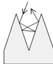
IMG.139 Mecanismo por el cual las cuñas anecoicas logran gran absorción sonora.
