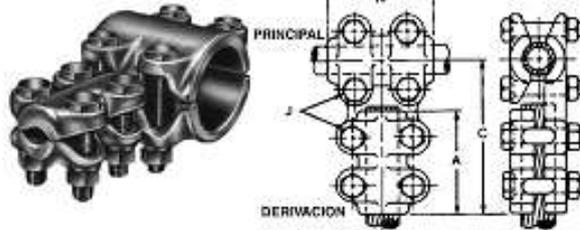
Estas Tees de Aleación de Aluminio se utilizan para derivar un cable de Aluminio o Cobre de una barra tubular principal de Aluminio. Poseen encastes hexagonales para la cabeza de los tornillos de ajuste lo cual, permite utilizar sólo una bocallave.
