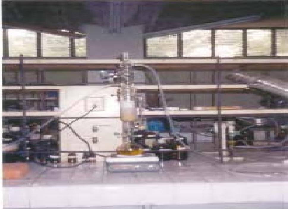
Figura N° 23. Aparato Soxhlet
