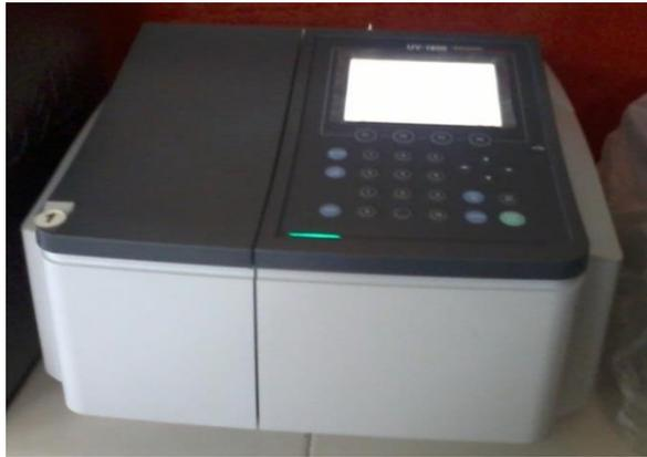
Figura N° 22: Espectrofotómetro UV-Visible utilizado en la Identificación, Valoración y Uniformidad de unidades de Dosificación de Principio activo en Suspensión oral de Albendazol 400mg.
