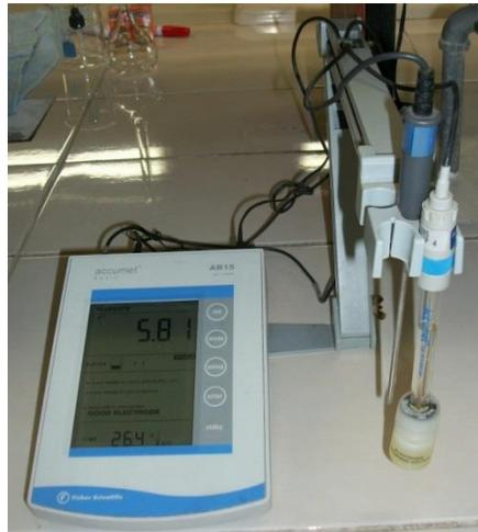
Figura N° 23: pHmetro utilizado en la toma de pH de muestras para el Albendazol en suspensión oral.
