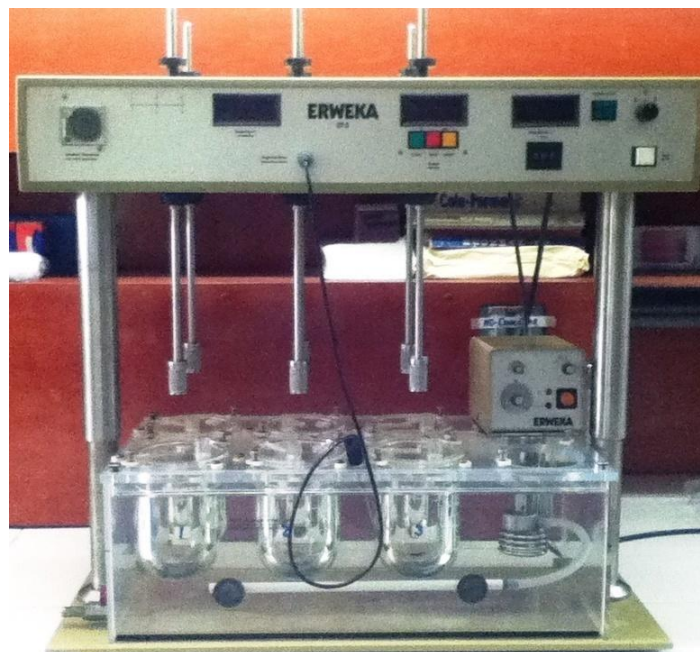
Figura N° 4: Aparato Disolutor, utilizado en la Prueba de Disolución.
