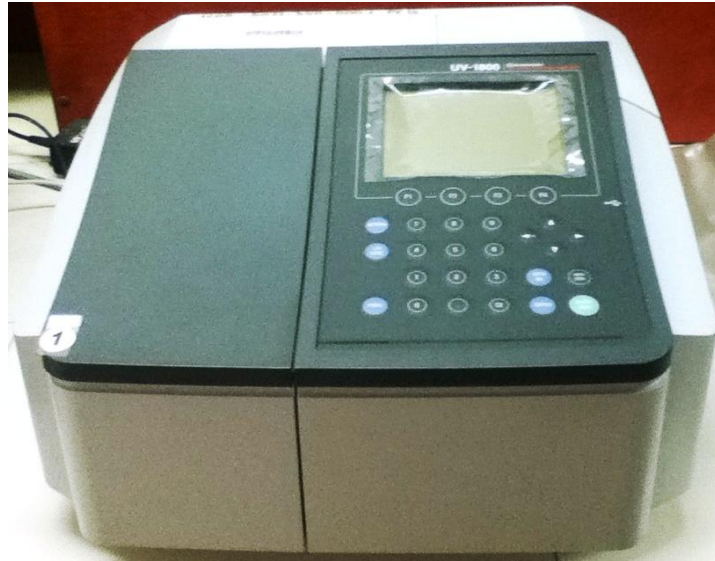
Figura N°3: Espectrofotómetro UV-VIS utilizado en la Identificación y Cuantificación de las Muestras.
