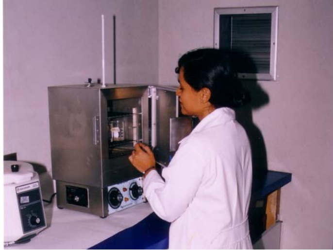
FIGURA N° 38: ESTUFA PARA ANÁLISIS DE PORCENTAJE DE HUMEDAD.
