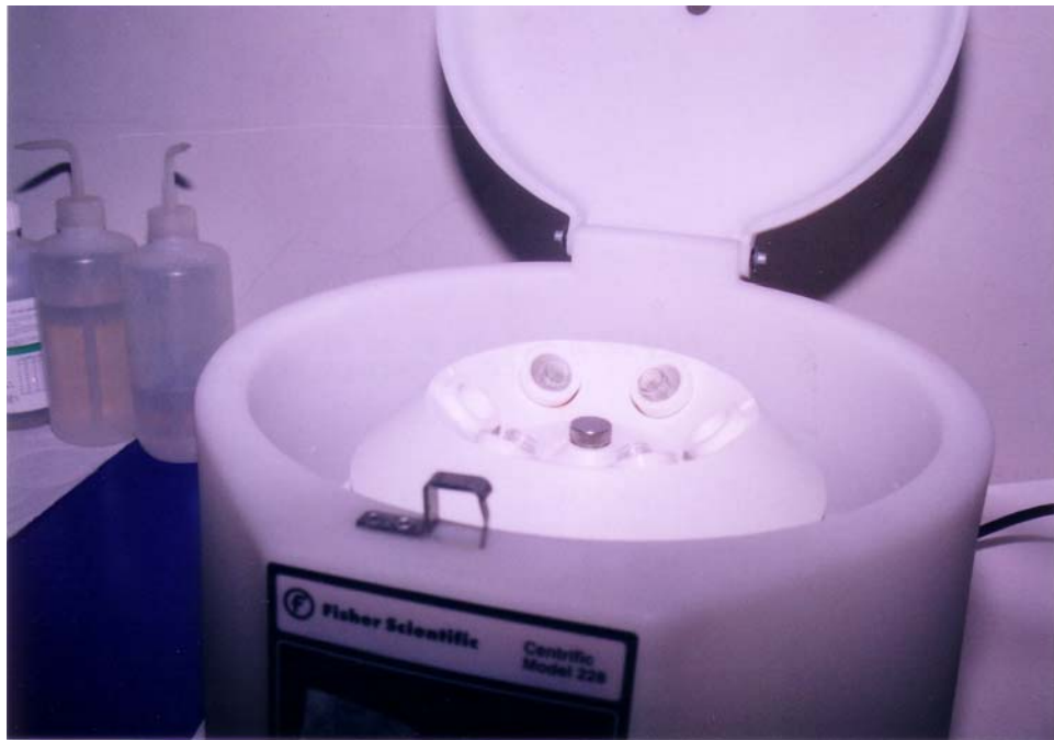
FIGURA N° 41: CENTRÍFUGA PARA LA DETERMINACIÓN DE pH.
