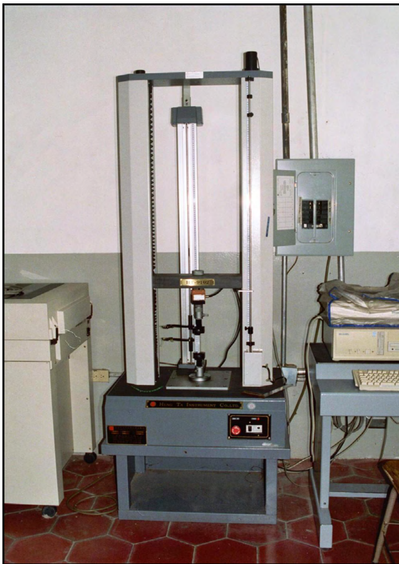
Figura No. 10. Máquina para realizar el ensayo de tensión marca HUNG - TA
