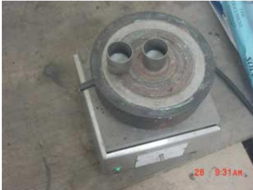
Anexo 4e. Evaporación de la muestra en baño de vapor.
