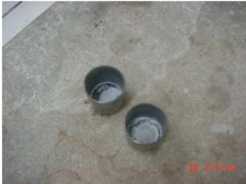
Anexo 4f. Cenizas de la muestra obtenidas luego de la incineración en la mufla.
