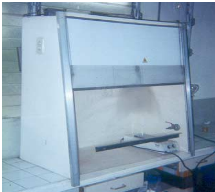
CAMARA DE EXTRACCIÓN DE GAS ESPECÍFICA PARA ÁCIDO PERCLORICO
