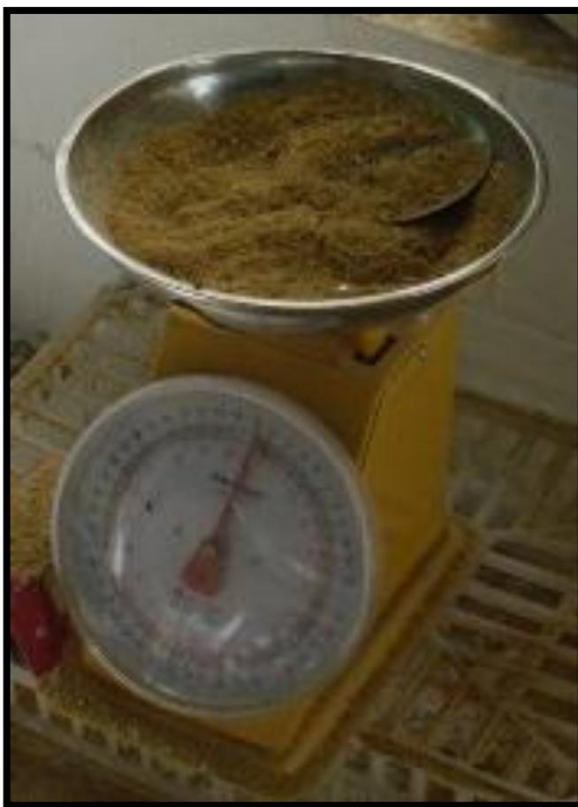
**Anexo 5. Balanza de reloj utilizada para el pesaje del concentrado y la harina de residuos de horchata**
