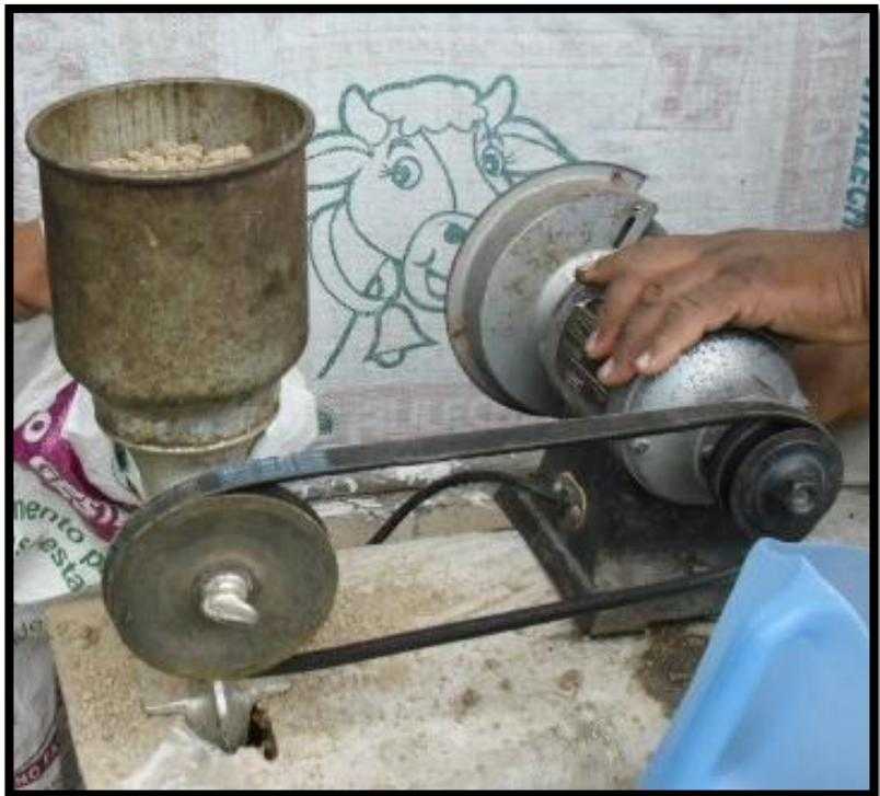
**Anexo 4. Molino de mano adaptado a motor eléctrico para el molido de los residuos de horchata.**
