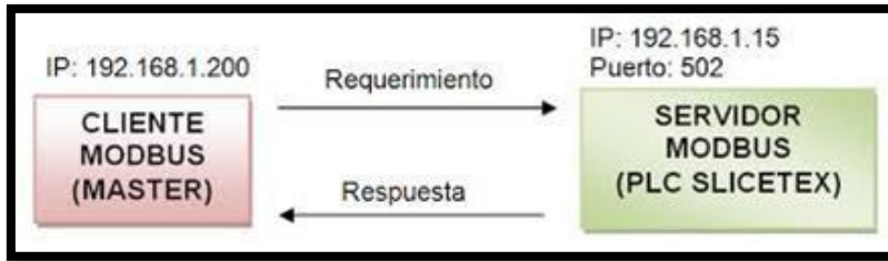
Figura B.4. Modbus cliente-servidor.
