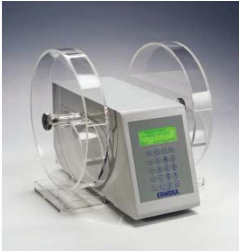
**FOTO 9. APARATO DE FRIABILIZACION ERWEKA , EQUIPO NECESARIO PARA DETERMINAR EL PORCENTAJE DE PERDIDA DE LAS TABLETAS EN EL TRANSPORTE DE LAS MISMAS**
