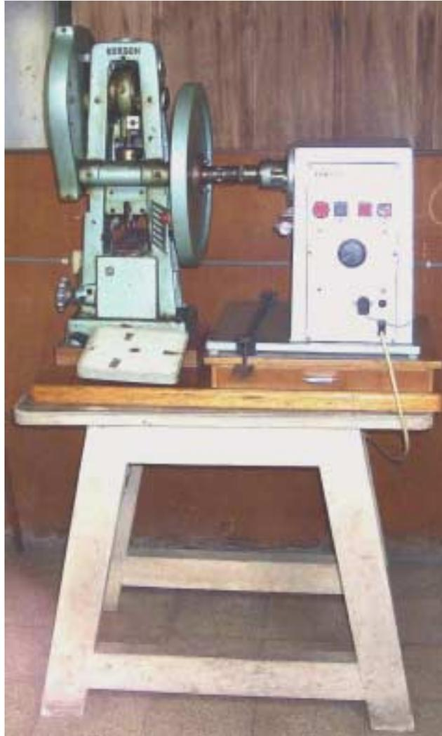
**FOTO 6. TABLETEADORA ERWEKA MONOPUNZON AUTOMATICA, EQUIPO NECESARIO PARA LA PRECOMPRESIÓN DE LAS TABLETAS, CON ELLA SE ELABORARON LOS TABLETONES**
