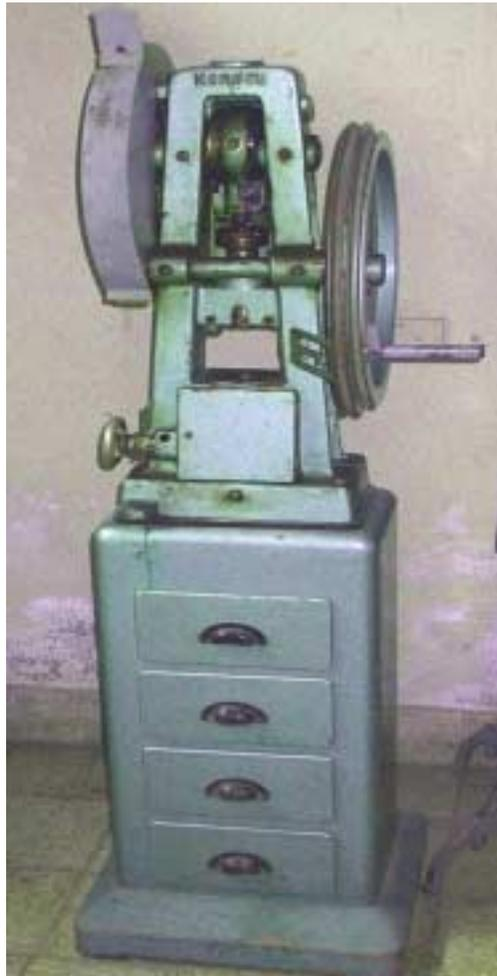
**FOTO 7. TABLETEADORA ERWEKA MONOPUNZON MANUAL, EQUIPO NECESARIO PARA LA COMPRESIÓN DE LAS TABLETAS ELABORADAS**
