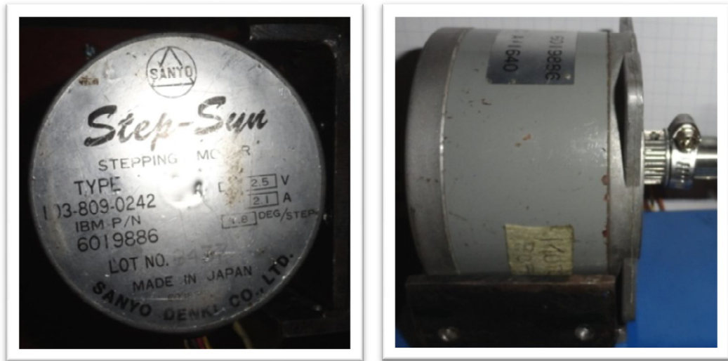
Figura 3.31 Motor de paso unipolar SANYO. Fuente: fotografía tomada por Oscar Cruz.
