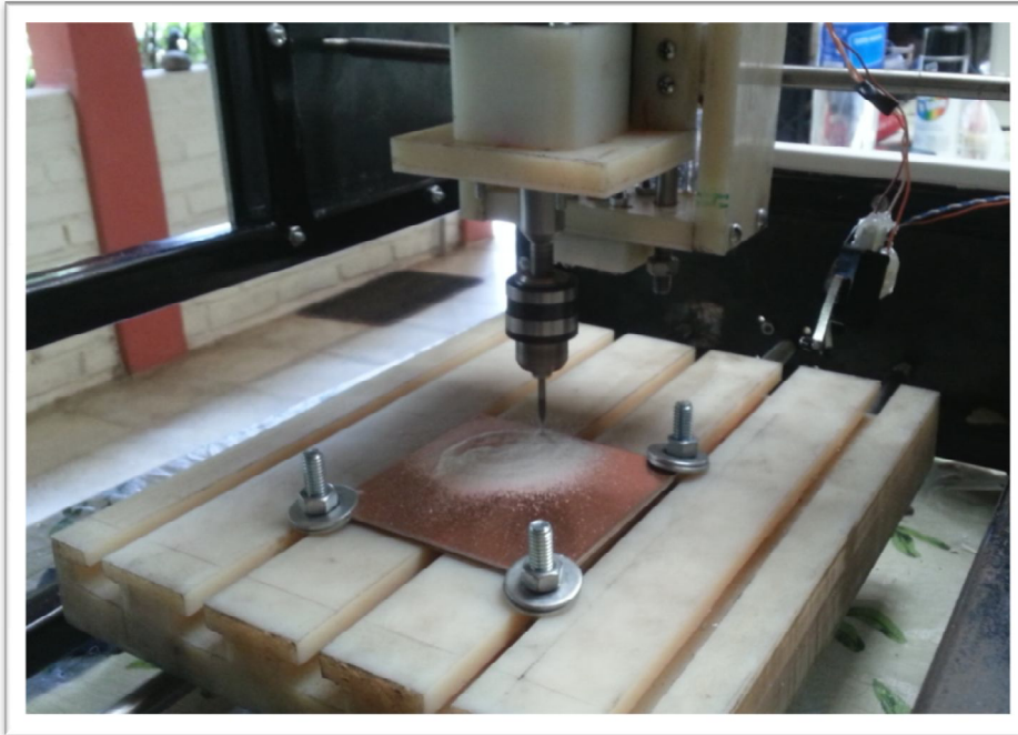
Figura 3.39 Prueba de maquinado de cobre, final. Fuente: fotografía tomada por Néstor Meza.
