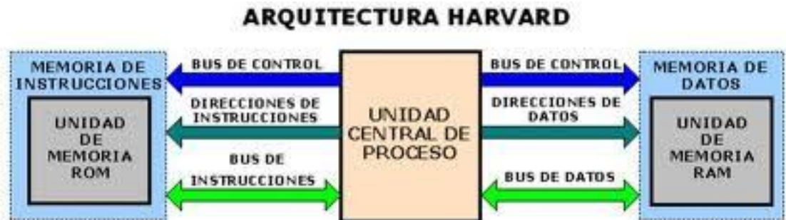
Fig. 1.25. Esquema de microcontrolador Harvard. Tomado de http://cursomicros.com
