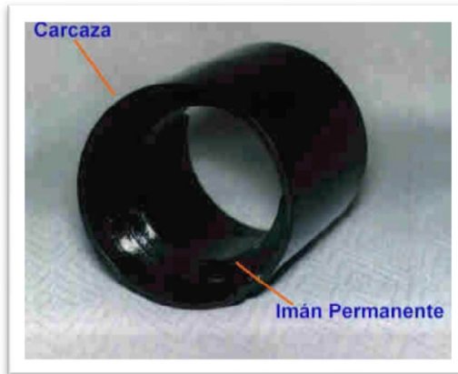
Figura 1.29. Detalle del estator.
