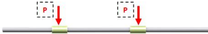
Figura 2.8 Diagrama de fuerzas que actúan sobre cada guía. Fuente: Elaborado por Rebeca Guerra.
