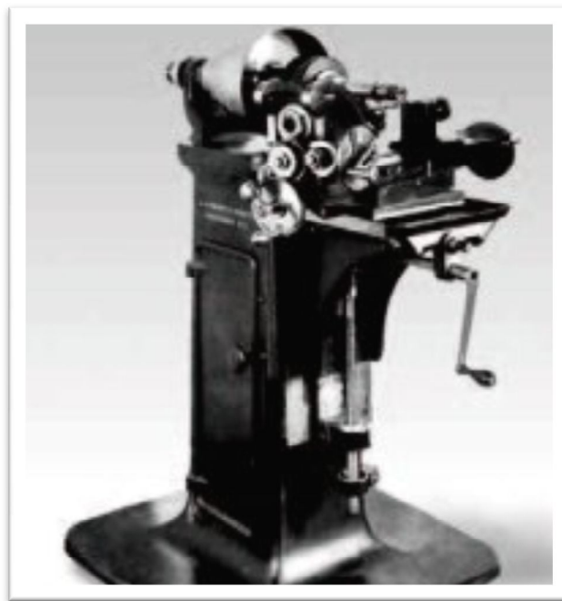
Figura 1.2. Fresadora vertical construida en 1857 por "Sharp, Stewart y Co" Fuente: http://es.wikipedia.org/wiki/Fresadora_de_control_num%C3%A9rico
