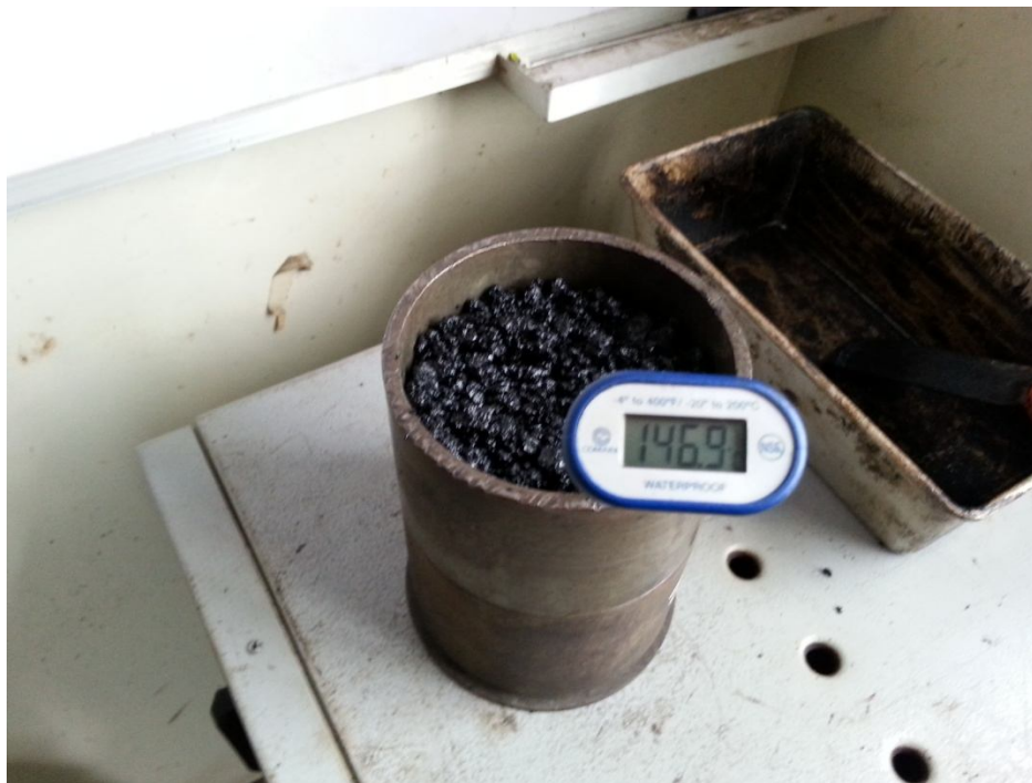
FIGURA N° 3.3 Fabricación de briquetas molde con segunda capa de mezcla asfáltica lista para compactar Imagen tomada en laboratorio de DISA Constructora.
