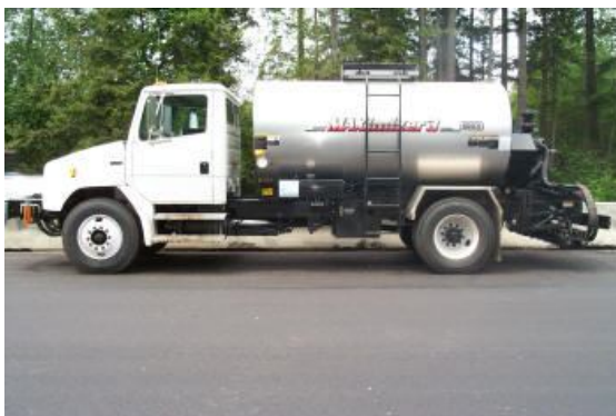
FIGURA N° 2.6 Camión Distribuidor del riego de liga
