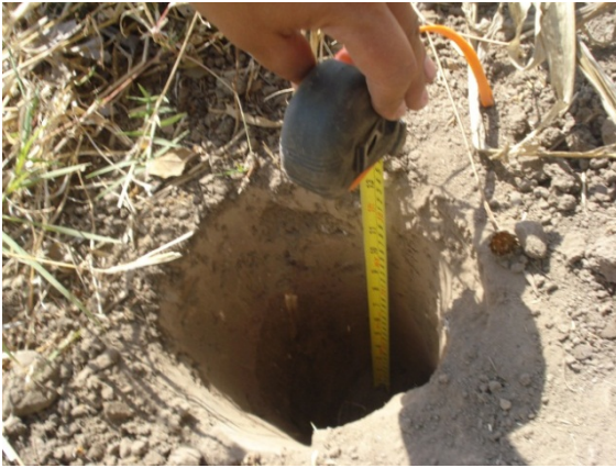
Figura A-5. Muestreo de suelo para análisis
