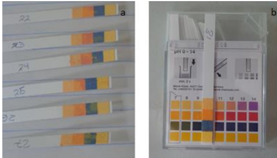
Figura 12. Toma de pH en saliva de serpientes: a) Tiras impregnadas con saliva de serpientes; b) Lectura de pH.
