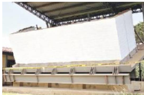
Fotografía F3.2a La fotografía: muestra la plataforma inclinada para realización de pruebas en instalaciones de la Universidad de El Salvador.
