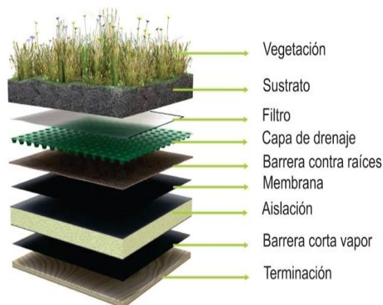
Esquema E3.3c "estructura de un techo verde; imagen extraída del sitio web: http://rotondaro.com.uy
