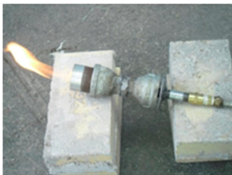
Ensayo independiente de cada uno de los quemadores
