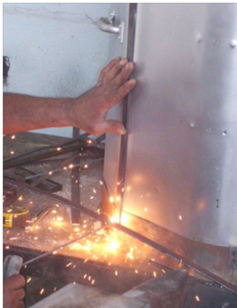
Momento en que se suelda la platina
