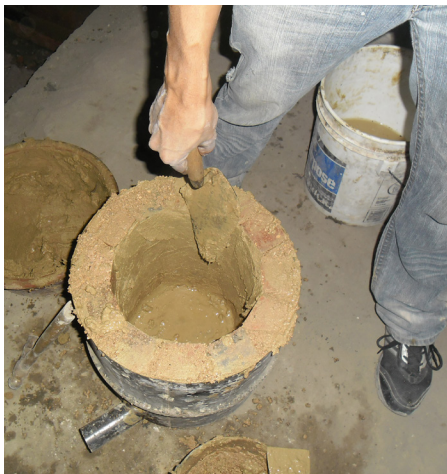
Revestimiento pegado de ladrillos refractarios con mezcla de barro y arena aplicado en un horno pequeño
