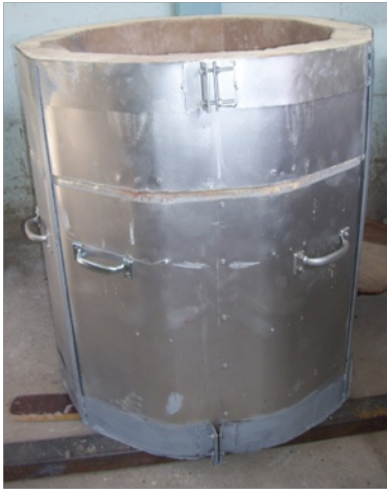
Unión de las dos partes del horno
