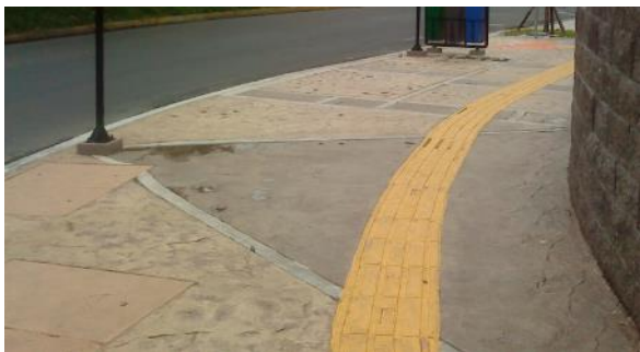
Foto 112. Uso de Bandas Direccionales en curvas
