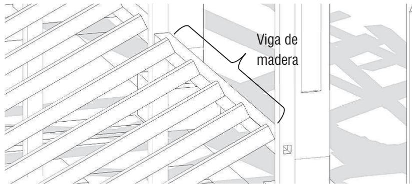
**Imagen N° 6.25 marco estructural y soporte de estructura de cubiertas templo Parroquial**
