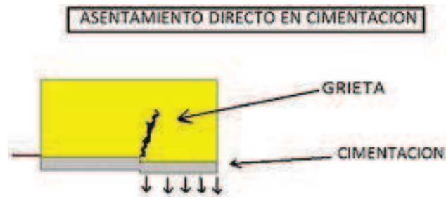
Imagen N° 7.1 Asentamiento del terreno Causa Directa de lesión
