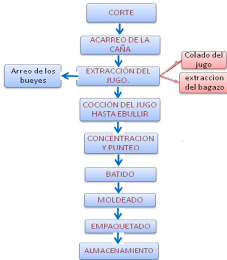
Figura 1. Diagrama de flujo de la producción de panela.
