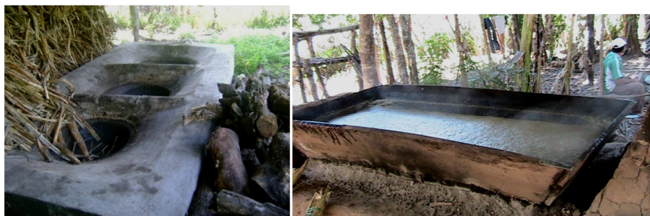
Figura 13. Perol (lado izquierdo) y lámina (lado derecho) para cocción del jugo de caña de azúcar en las molindas.
