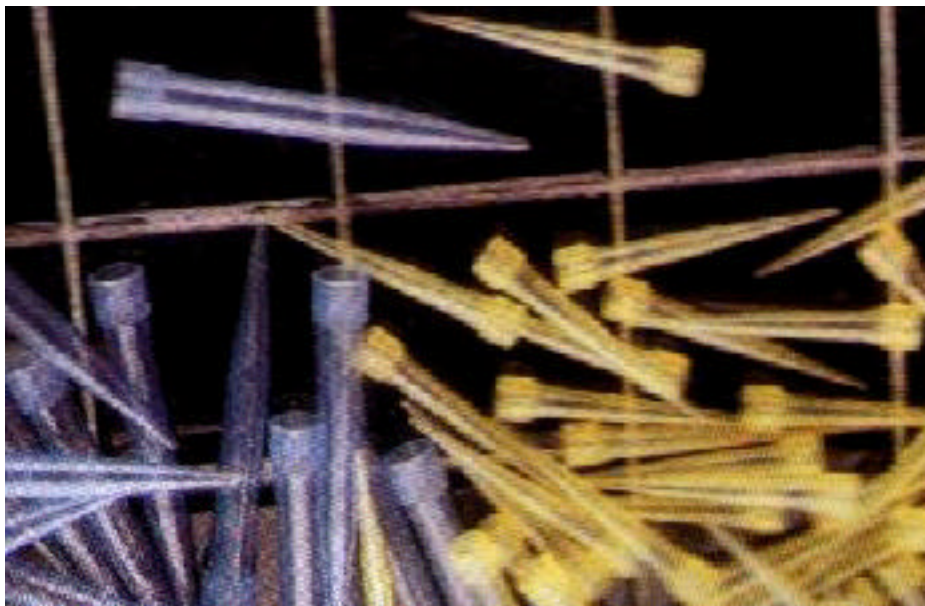
PUNTAS Para micropipetas Utilizadas en el Bioensayo de Citotoxicidad con Artemia salina .
