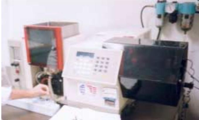
Fig. No. 7 Espectrofotómetro de Absorción Atómica Perkin-Elmer 3100. Aparato utilizado para determinación de Hierro, Calcio y otros minerales.
