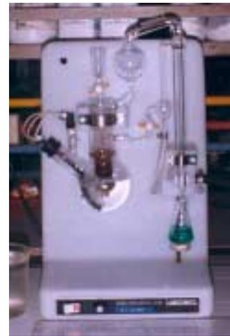
Fig. No. 5. Destilador Microkjeldahl.
