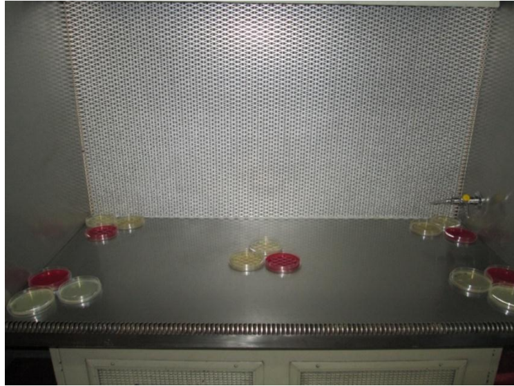
Figura N°13 Colocar placas estériles con medio de cultivo TSA, agar sangre y papadextrosa en 5 puntos de la cabina, en sus dos extremos internos y externos y al centro de la cabina 6 minutos antes de iniciar la jornada de trabajo.
