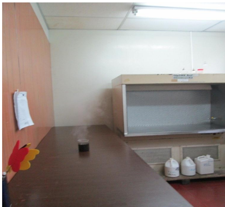
Figura N°7 De contaminación en el área de preparación de vacunas hipo alergénicas con vapores de formaldehído y permanganato de potasio.
