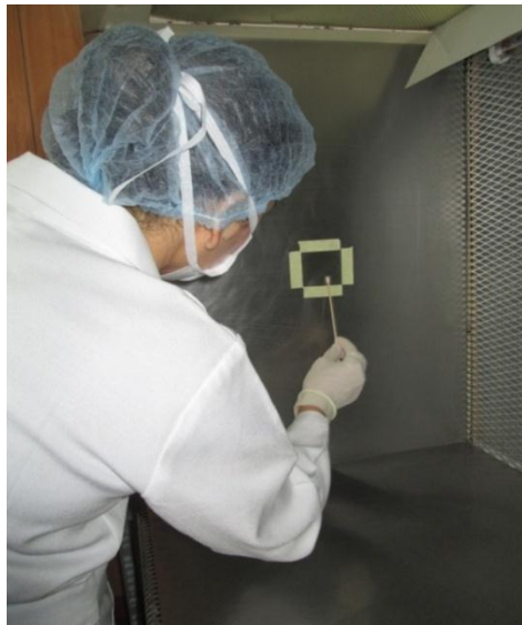
Figura N°13 Pasar hisopo impregnado de solución salina en una plantilla de 25 cm 2 en los puntos de muestreo.
