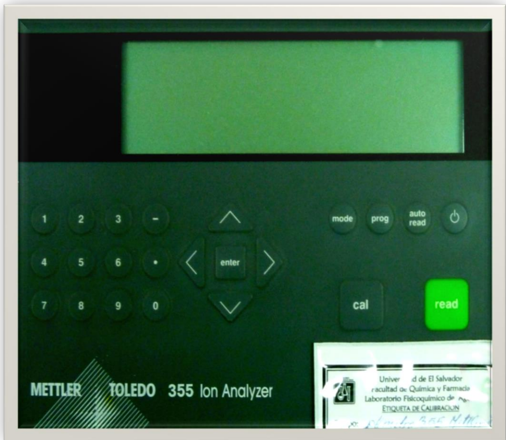
Figura N°3: Panel de control del Potenciómetro Mettler Toledo 355
