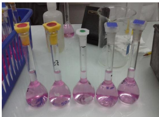
(K) Solución estándar para curva de calibración
