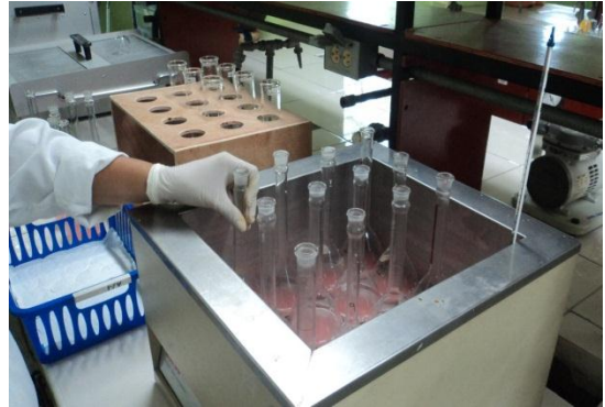
(F) Colocación en baño maría de soluciones muestras
