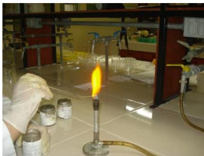
**Figura N°6** Prueba B, Identificación de Sodio de la muestra N° 11
