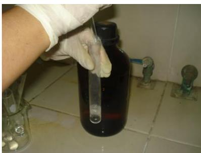
**Figura N°7** Prueba A, Identificación de Bicarbonato de la muestra N° 11
