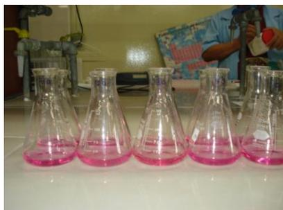
**Figura N°14** Punto final de la valoración del Ensayo para  $\text{NaHCO}_3$
