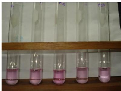
**Figura N°9** Prueba C, Identificación de Bicarbonato
