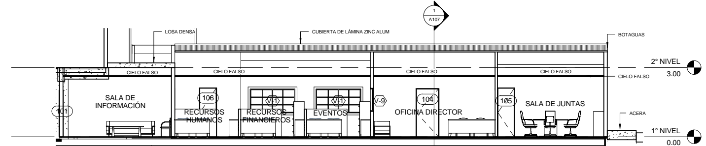
2 SECCION LONGITUDINAL ADMINISTRACION 1:75
