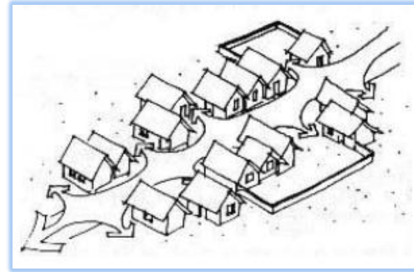
Imagen N° 08 Buena orientación de la circulación para aprovechar la ventilación natural.
