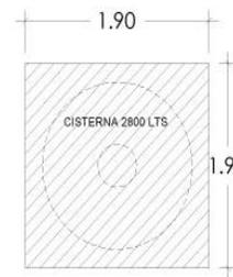
**PLANTA DE EXCAVACION CISTERNA**
