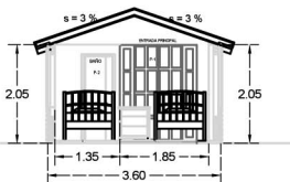
SECCION C-C CABAÑA ESC.: 1:150
