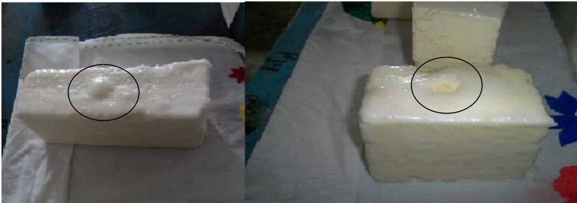
Imagen 15. Deterioro de la parafina a causa de altas temperaturas y daño mecánico en el tratamiento T1.
