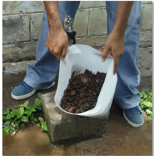
Lavado del material retenido en malla No.4
