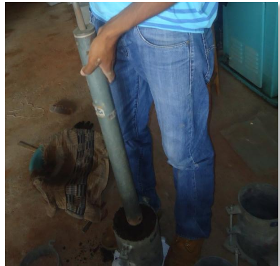
Compactación de materiales en molde de CBR, a 56, 25 y 10 golpes por capa
