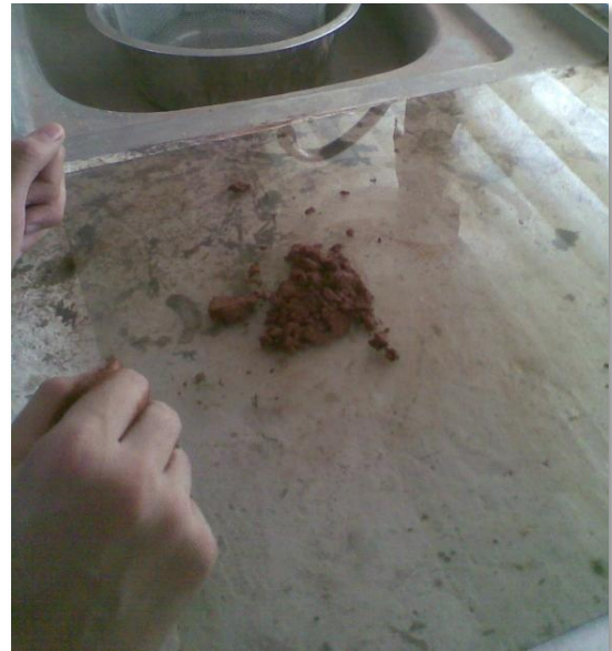
Deformación de espécimen de prueba por carencia de propiedades cohesivas
