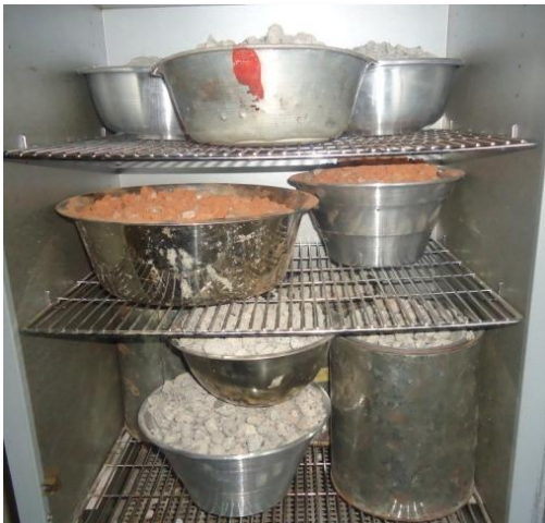
Secado de materiales en horno durante 24 h.
