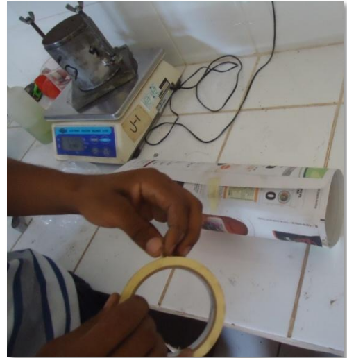
Espécimen de suelo-cemento en envoltura de papel periódico
