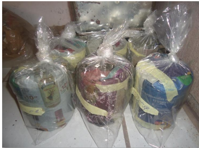
Curado de especímenes de suelo-cemento, método utilizado en nuestro medio.
