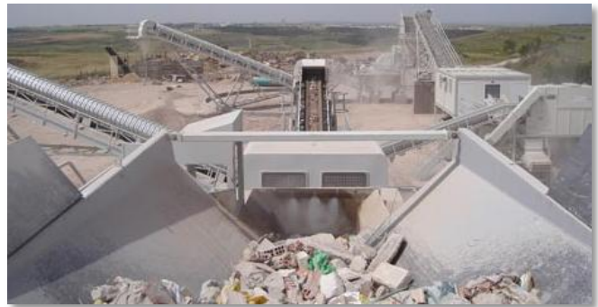
Fotografía 5. 5 Planta estacionaria para reciclaje de RCD Fuente: biurrarena.com
