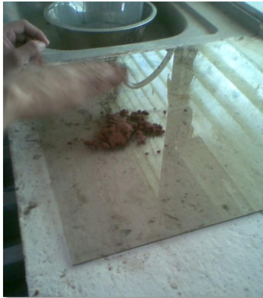
Deformación de espécimen de prueba por carencia de propiedades cohesivas
