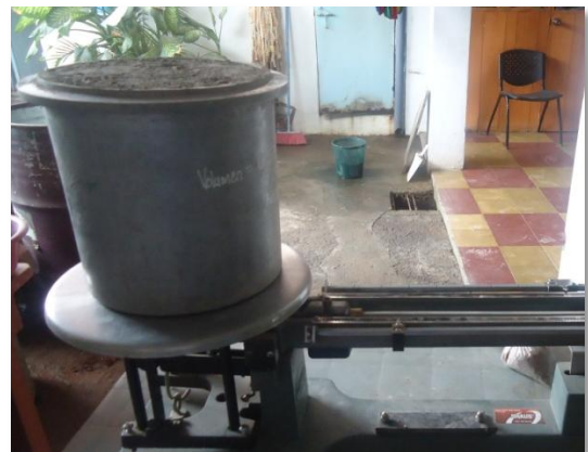
Pesaje material más medidor metálico, peso unitario suelto y peso unitario.
