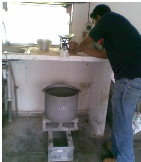
Colocación de equipo para pesaje del material saturado en condición sumergida
