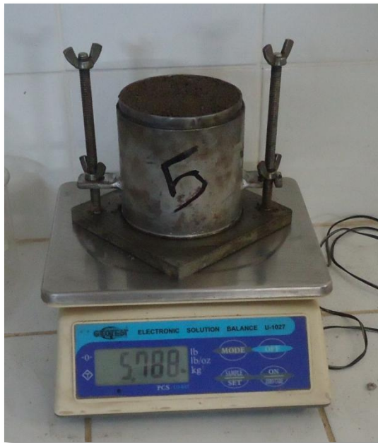
Pesaje de probetas mas molde de proctor
