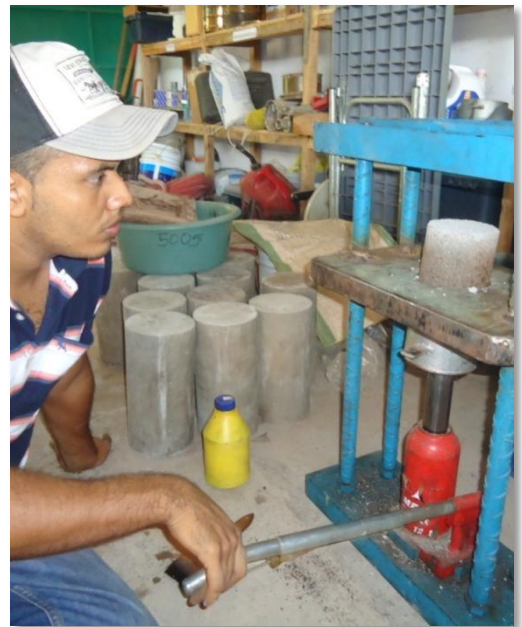
Extracción del espécimen de suelo-cemento
