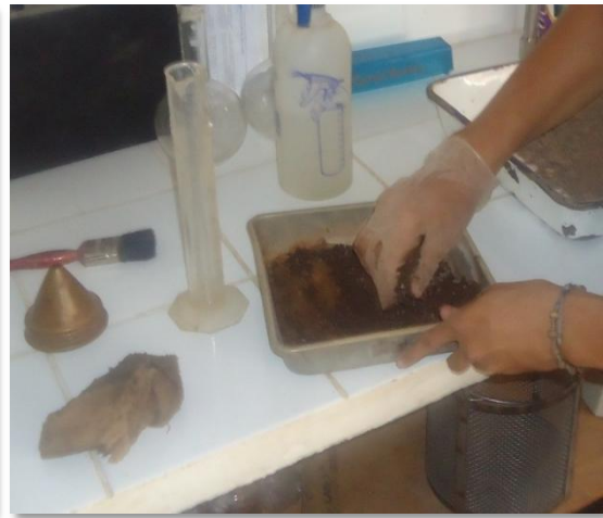
Determinación de humedad inicial de ensayo
