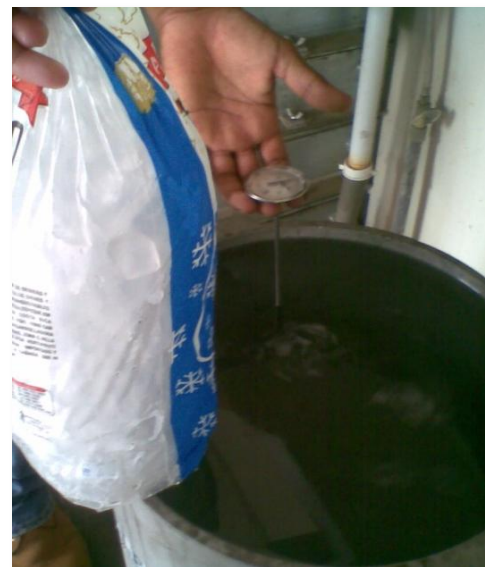
Medición de temperatura, estabilización de temperatura con hielo.
