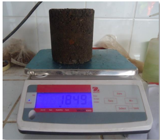
Pesaje de especímenes antes de someterlos a compresión.
