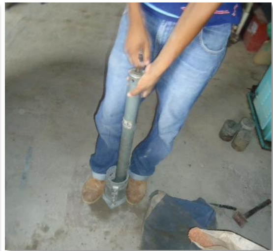
Ejecución del ensayo de compactación
