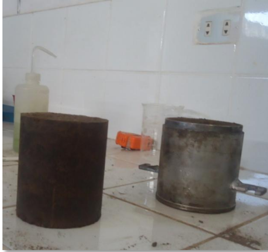
Espécimen de suelo-cemento, concreto triturado.
