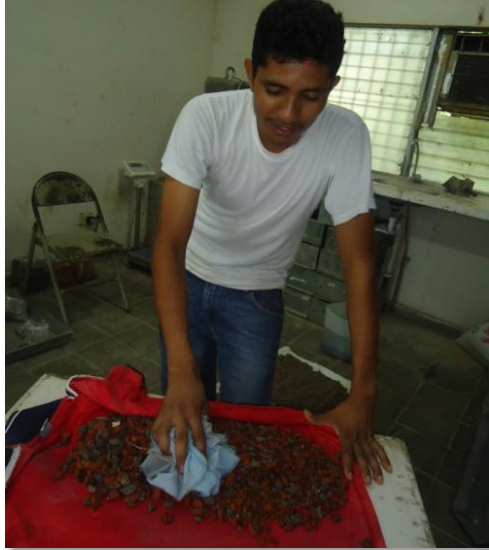
Llevando materiales a condición Saturado Superficialmente Seco (SSS)
