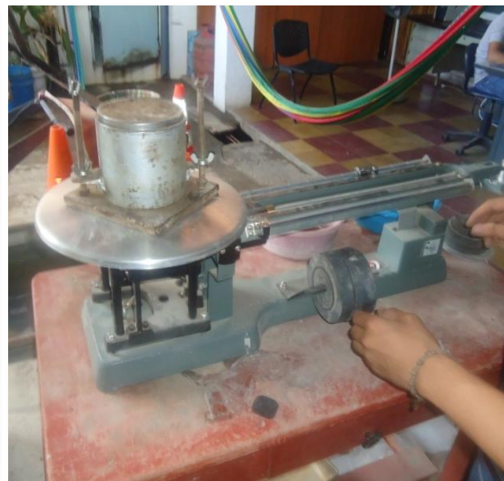
Pesaje de molde + Material Húmedo
