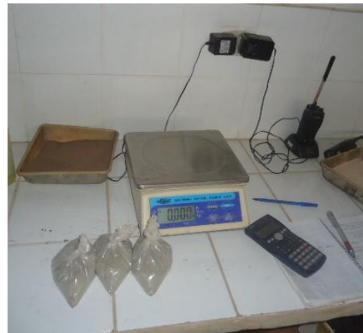
Pesaje de cemento
