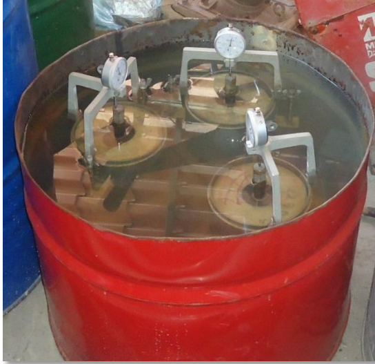
Saturación los especímenes
