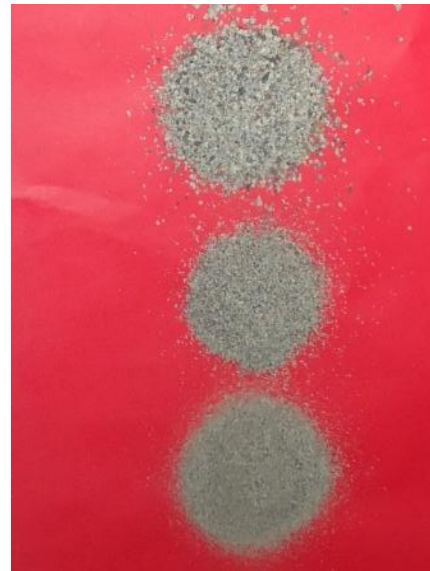
Tamizado de Material que pasa la malla No. 4 despues de lavado por la No. 200
