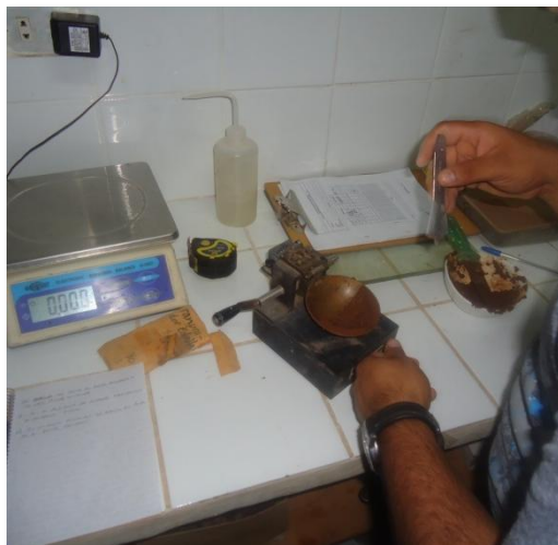
Colocación de muestra en maquina Casagrande
