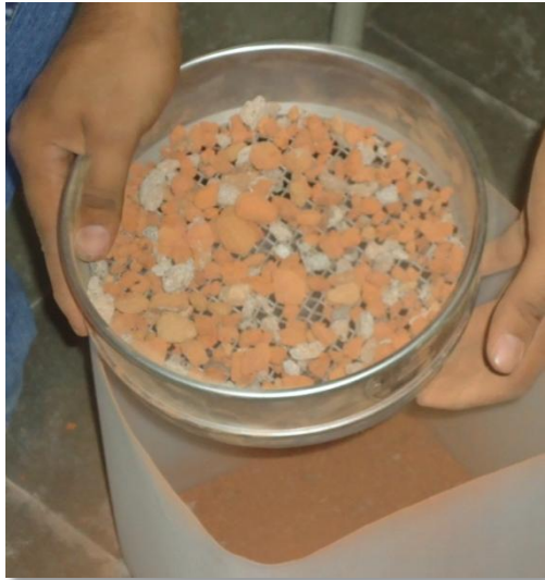
Tamizado del Material por malla No. 4
