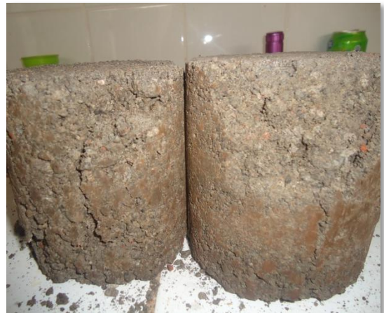
Especímenes luego de ser ensayados a compresión.
