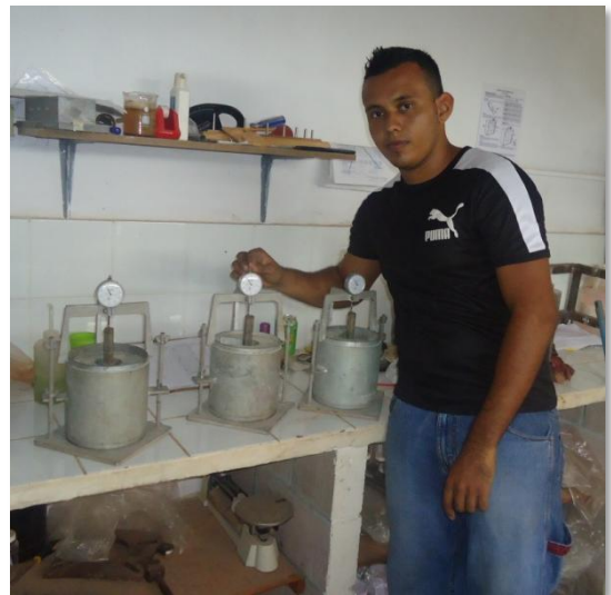
Colocación de trípode y dial para medir deformaciones
