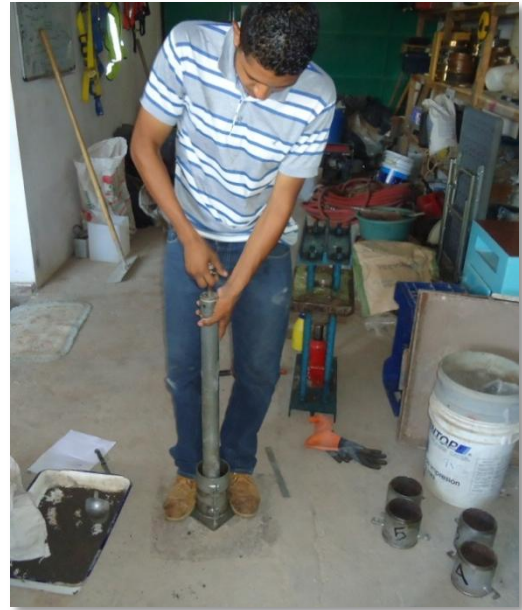
Ejecución del ensayo de compactación
