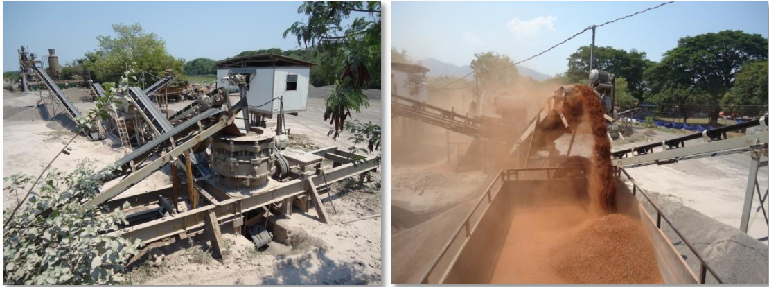
Fotografía 1. 4 Maquinaria utilizada para la trituración de los RCD.
