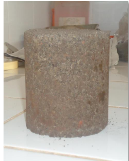
Fotografía 5. 2 Suelo-cemento, sustituyendo material terreo por residuos de concreto reciclados.
