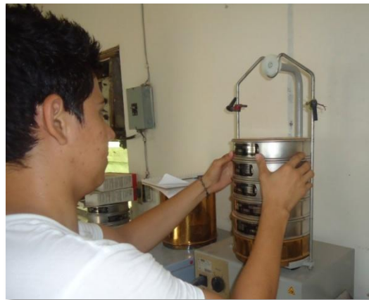
Tamizado de los materiales en Rop -Tap
