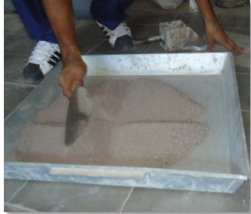
Cuarteo de material que pasa malla No. 4, para posterior lavado.
