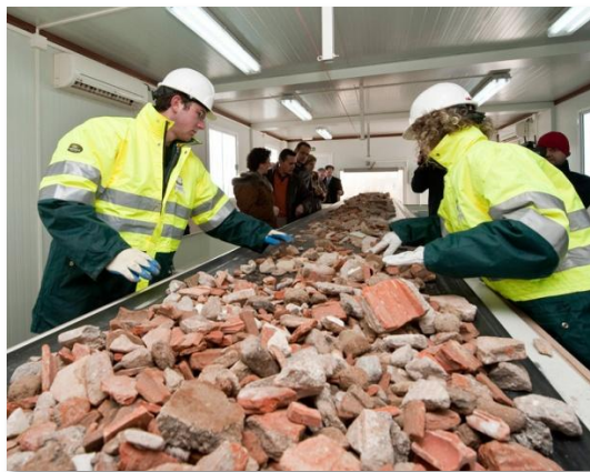
Fotografía 5. 4 Clasificación de residuos de construcción y demolición en planta.
