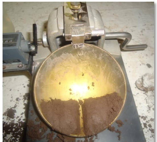
Ejecución de prueba para determinar Limite Liquido
