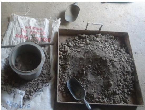
Ejecución de la prueba, en la imagen cucharón, medidor metálico, varilla metálica y materiales.
