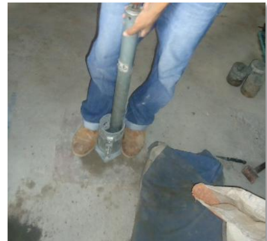
Ejecución del ensayo de compactación
