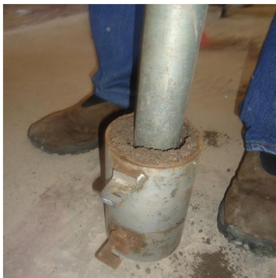
Extracción de muestras para determinar humedad
