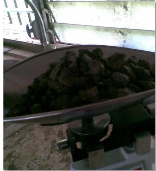
Pesado de material en condición SSS
