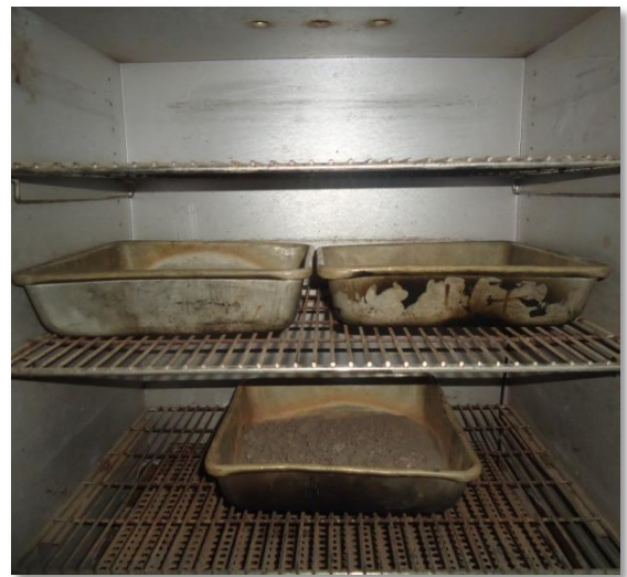
Calculo de la humedad de los especímenes
