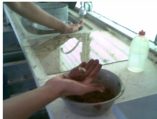
Ejecución de prueba para determinar limite plástico
