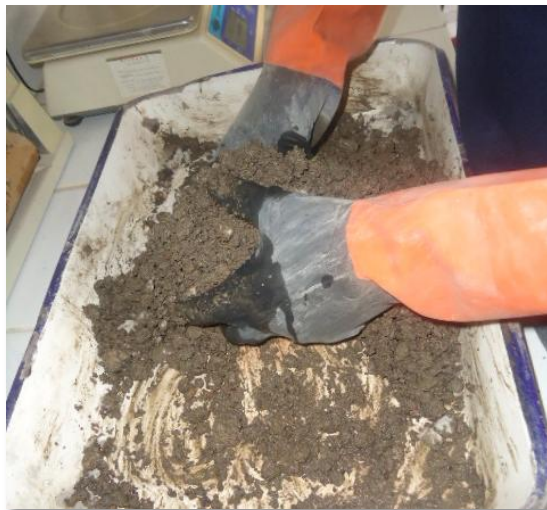
Homogenización de la muestra para ensayo
