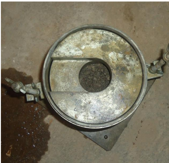
Colocación de contrapesos anulares
