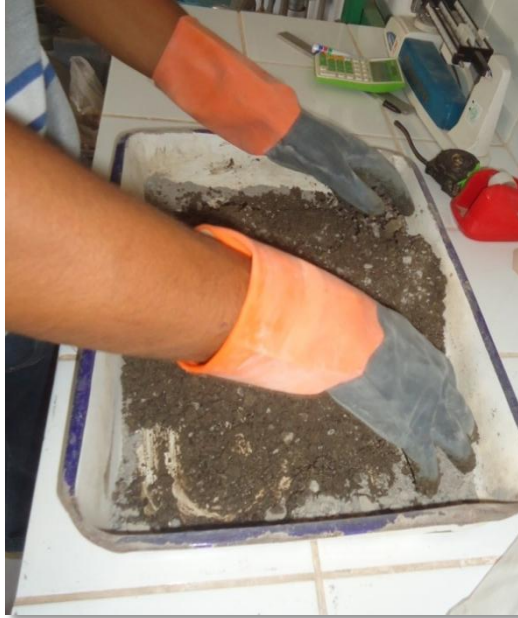
Mezclado de agua cemento y material
