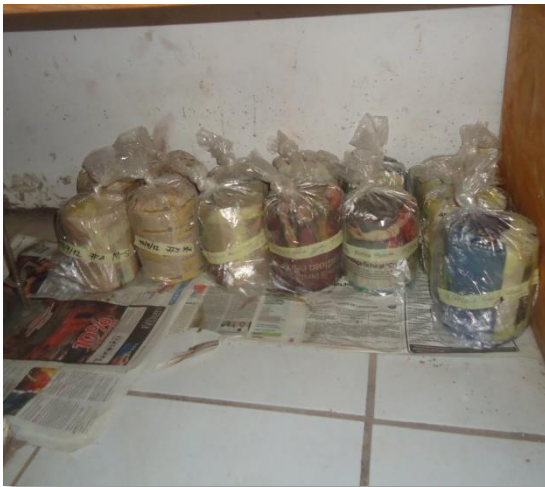
Curado de especímenes para luego someterlos a compresión.
