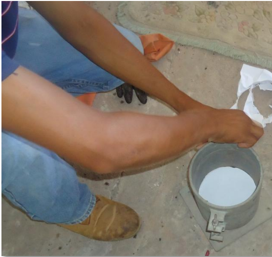
Colocación del papel filtro grueso
