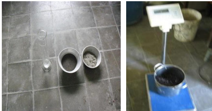
Figura 4.1.3e Pesando las muestras
