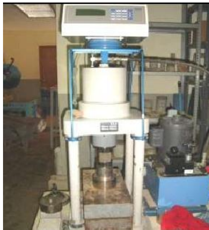
Figura 4.1.4j Colocando los especímenes en la máquina de ensayos
