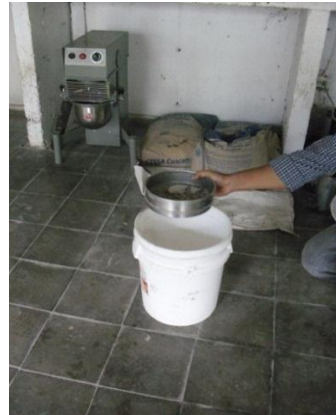
Figura 4.1.4c Tamizando el cemento.
