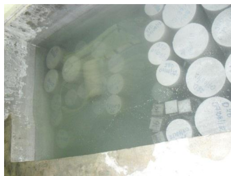
Figura 4.1.3i Curado de especímenes.
