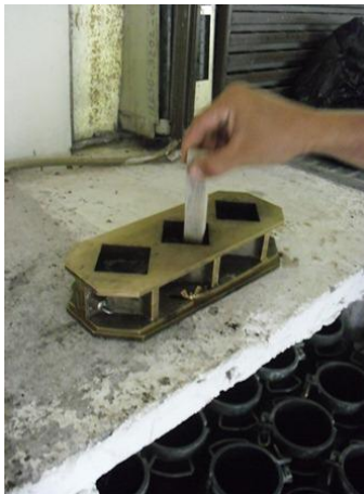
Figura 4.2.2d Acomodando el mortero en los moldes cúbicos.
