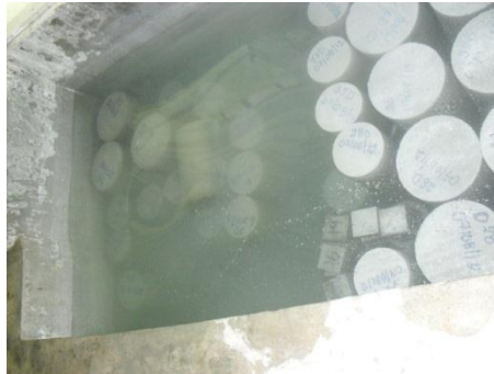
Figura 4.2.2e Curado de especímenes.
