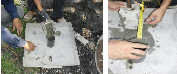
Figura 4.2.2c Consistencia de Flujo en Material de Resistencia Baja Controlada.
