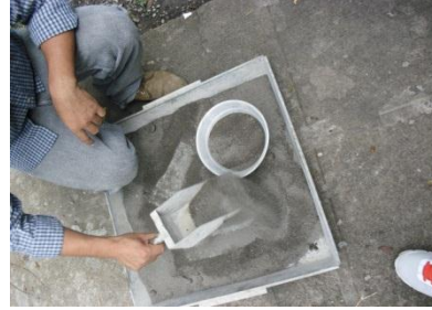
Figura 4.1.3d Extrayendo una muestra ya seca.
