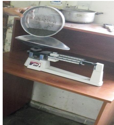
Figura 4.1.1h Pesando los porcentajes retenidos de la muestra de agregado en cada malla.
