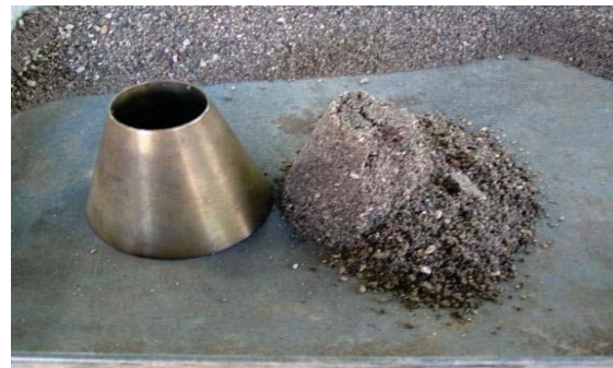
Figura 4.1.2c Colocando una porción de agregado fino parcialmente seco y suelto dentro del molde, llenando lo hasta que se desborde sosteniéndolo con los dedos.
