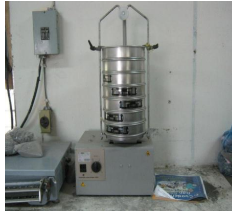
Figura 4.1.1g Agitar los tamices por medio mecánico.
