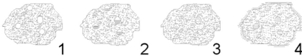
Figura 4.1.2a. Estados de saturación de los agregados
