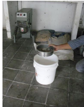
Figura 4.1.3c Tamizando el cemento.
