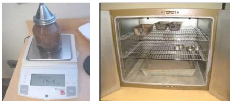
Figura 4.1.2f Pesando y colocando el contenido del picnómetro en una tara de peso conocido, se coloca en el horno.
