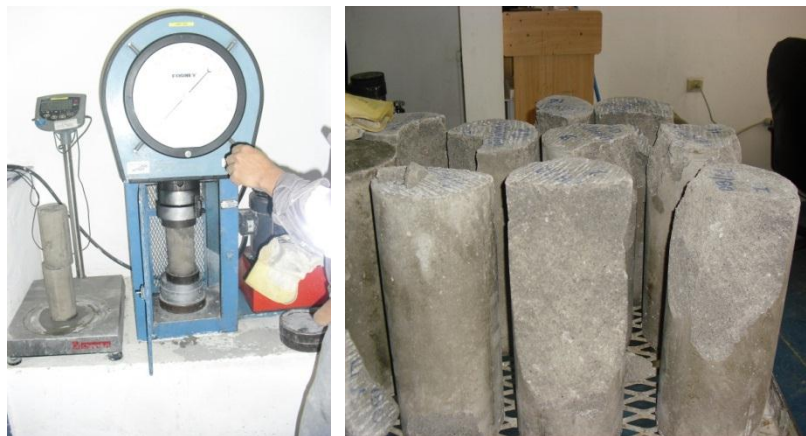
Figura 4.2.1f Colocando los especímenes en la máquina de ensayos
