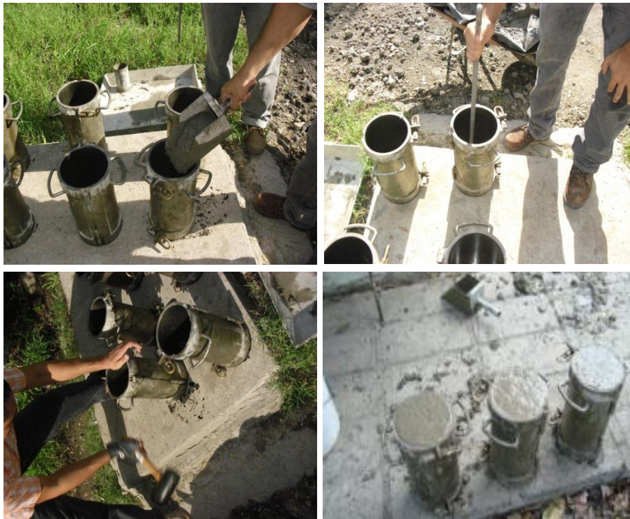
Figura 4.2.1d Llenando los cilindros en tres capas de igual altura
