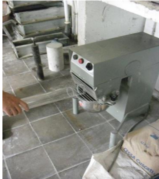
Figura 4.1.4f Mezclando mecánicamente los materiales
