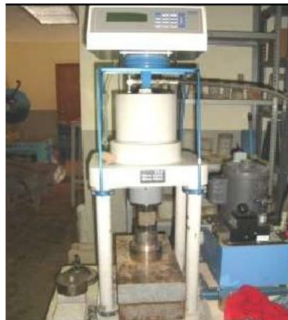
Figura 4.2.2f Colocando los especímenes en la máquina de ensayos
