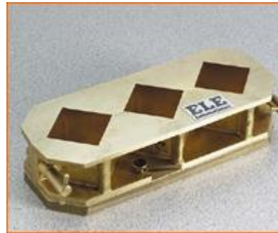
Figura 4.1.4a Moldes limpios y debidamente engrasados.
