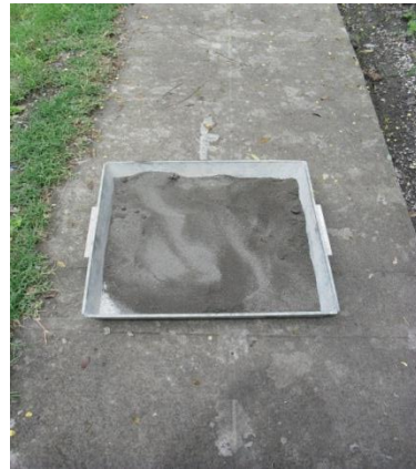
Figura 4.1.1b Secando las muestras a temperatura ambiente.
