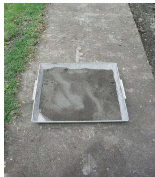
Figura 4.1.4b Secando las muestras a temperatura ambiente.
