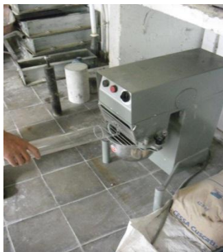
Figura 4.1.3f Mezclando mecánicamente los materiales.
