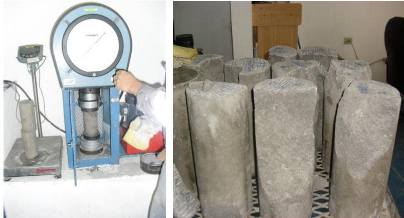
Figura 4.1.3j Colocando los especímenes en la máquina de ensayos.
