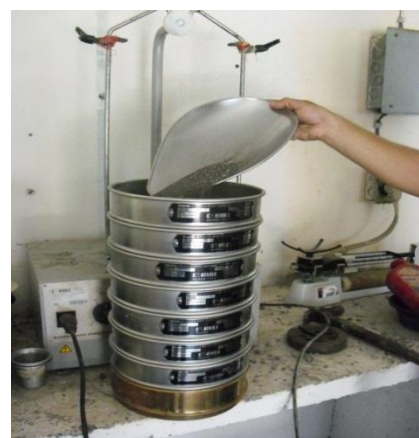
Figura 4.1.1f Colocando la muestra desde la parte superior
