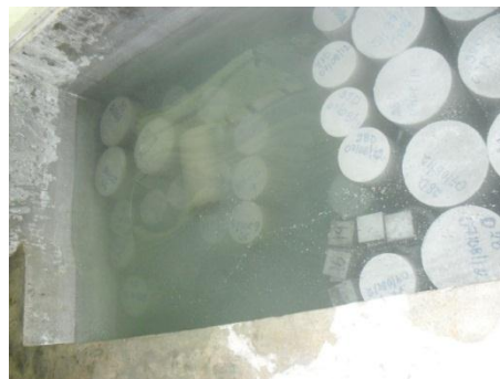
Figura 4.1.4i Curado de especímenes.
