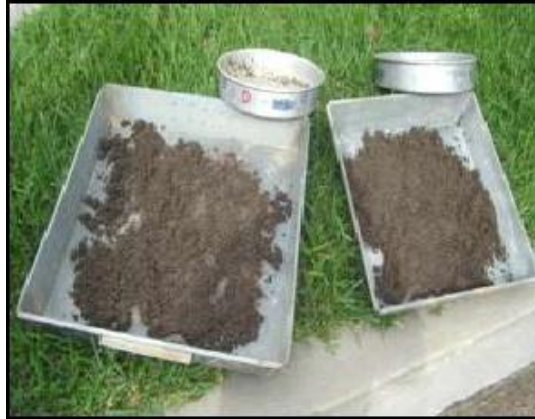
Figura 4.1.2b Tomando dos muestras de material que pasen la malla # 4
