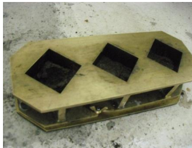
Figura 4.2.2a Moldes limpios y debidamente engrasados.
