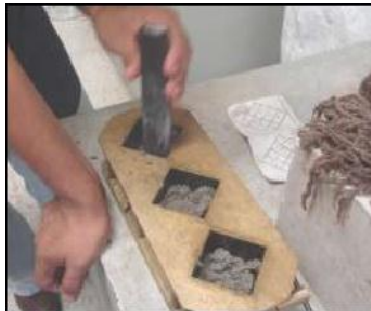
Figura 4.1.4h Acomodando el mortero en los moldes cúbicos
