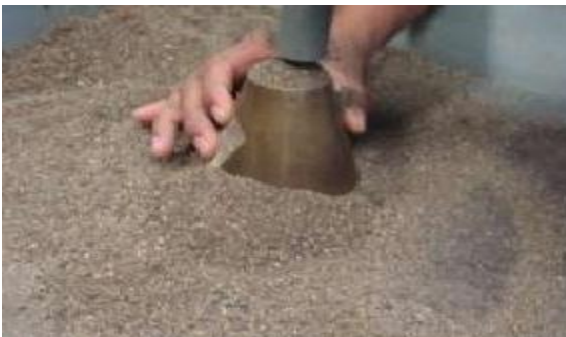
Figura 4.1.2c Colocando una porción de agregado fino parcialmente seco y suelto dentro del molde, llenando lo hasta que se desborde sosteniéndolo con los dedos.
