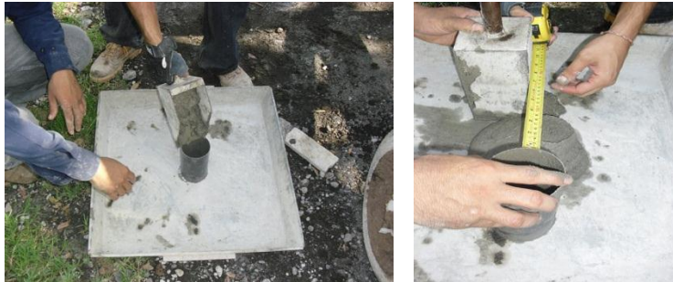
Figura 4.2.1c Consistencia de Flujo en Material de Resistencia Baja Controlada.
