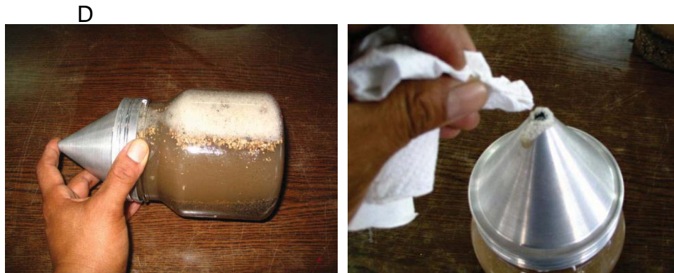
Figura 4.1.2e Agitando el picnómetro para eliminar todas las burbujas de aire
