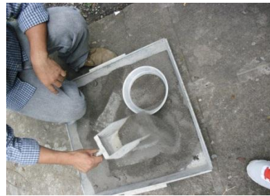
Figura 4.1.4d Extrayendo una muestra ya seca.
