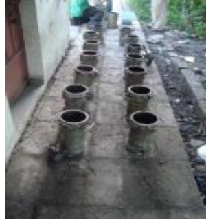
Figura 4.1.3a Moldes limpios y debidamente engrasados.
