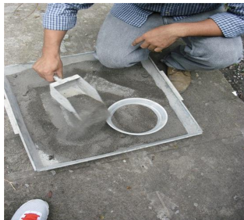
Figura 4.1.1c Extrayendo una muestra ya seca.
