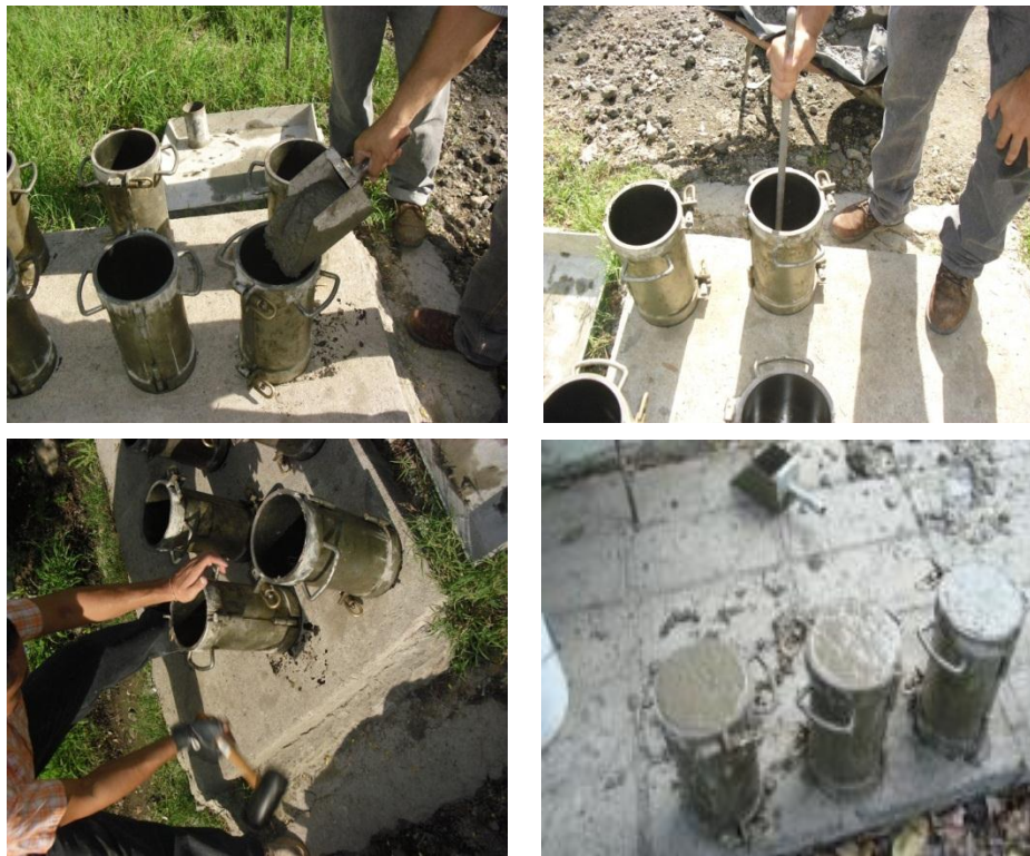
Figura 4.1.3h Llenando los cilindros en tres capas de igual altura.
