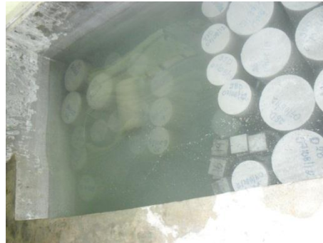
Figura 4.2.1e Curado de especímenes.
