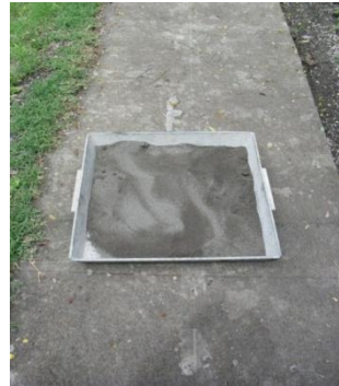
Figura 4.1.3b Secando las muestras a temperatura ambiente.
