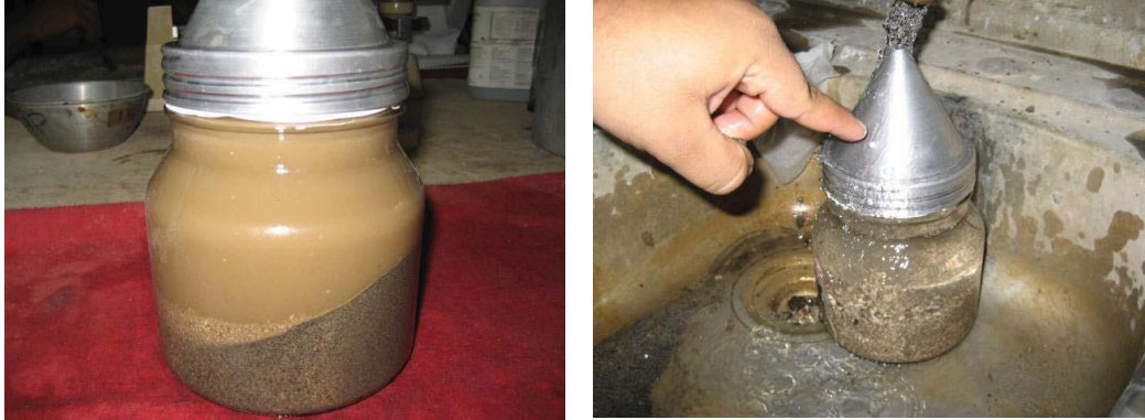
Figura 4.1.2d Pesando 500 gramos de arena y llenando parcialmente el picnómetro con agua
