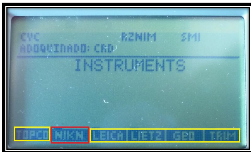
Figura 2.71 Opciones de Instrumentos o tipos de Estaciones Totales
