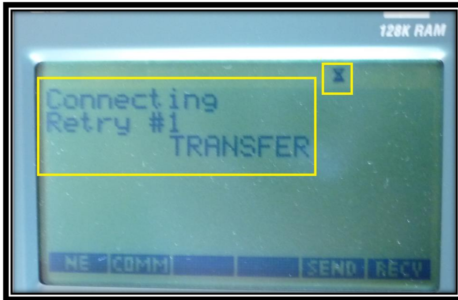
Figura 2.177 Mensaje de que el colector está recibiendo los puntos
