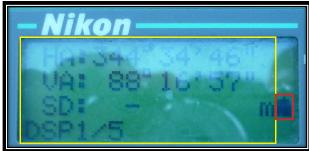
Figura 2.77 Símbolo de carga de la batería de la Estación Total
