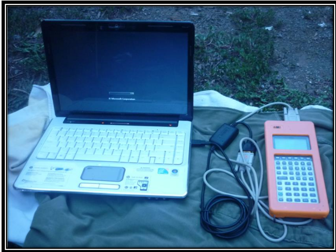
Figura 2.136 Computadora y Colector conectados para la descarga de puntos
