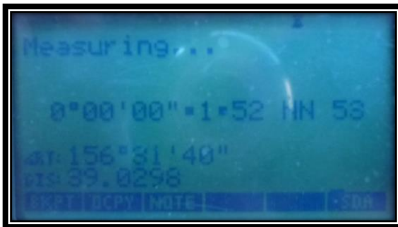
Figura 2.115 Colector recibiendo ángulo y distancia
