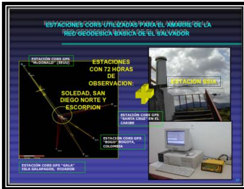
Figura 3.27 Estaciones CORS utilizadas para el amarre de la Red Geodésica Básica de El Salvador.
