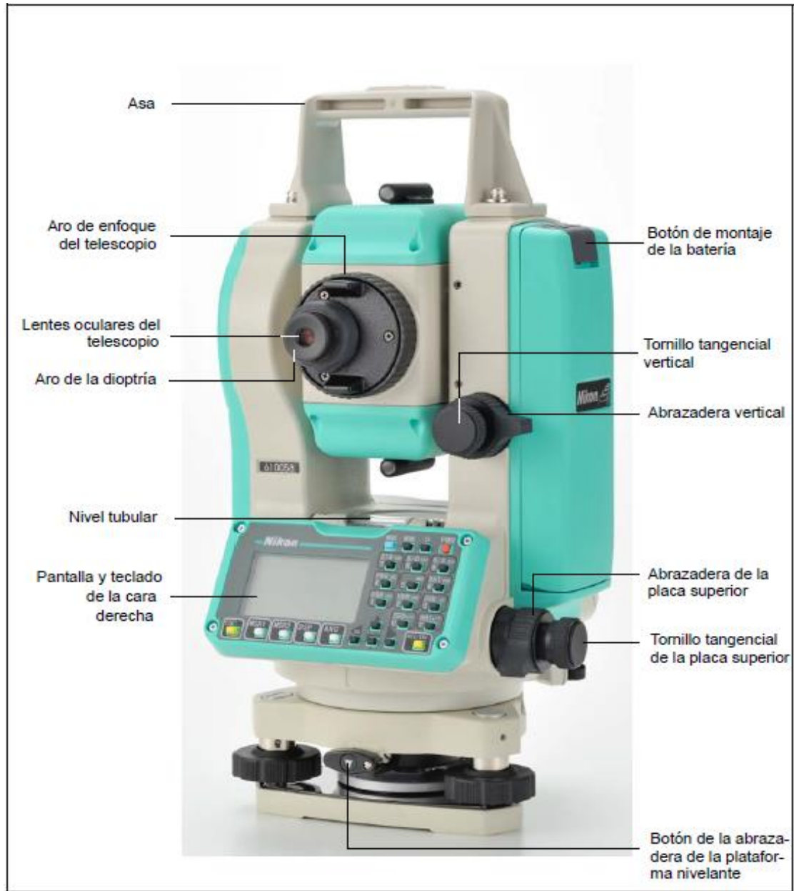
Figura 2.11 Partes Principales de la Estación Total
