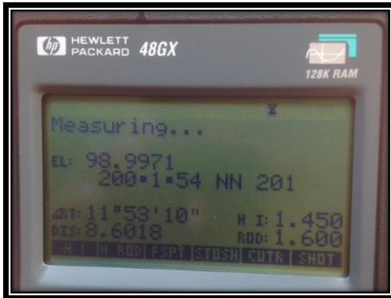
Figura 5.41 Esperando que reciba la distancia el Colector
