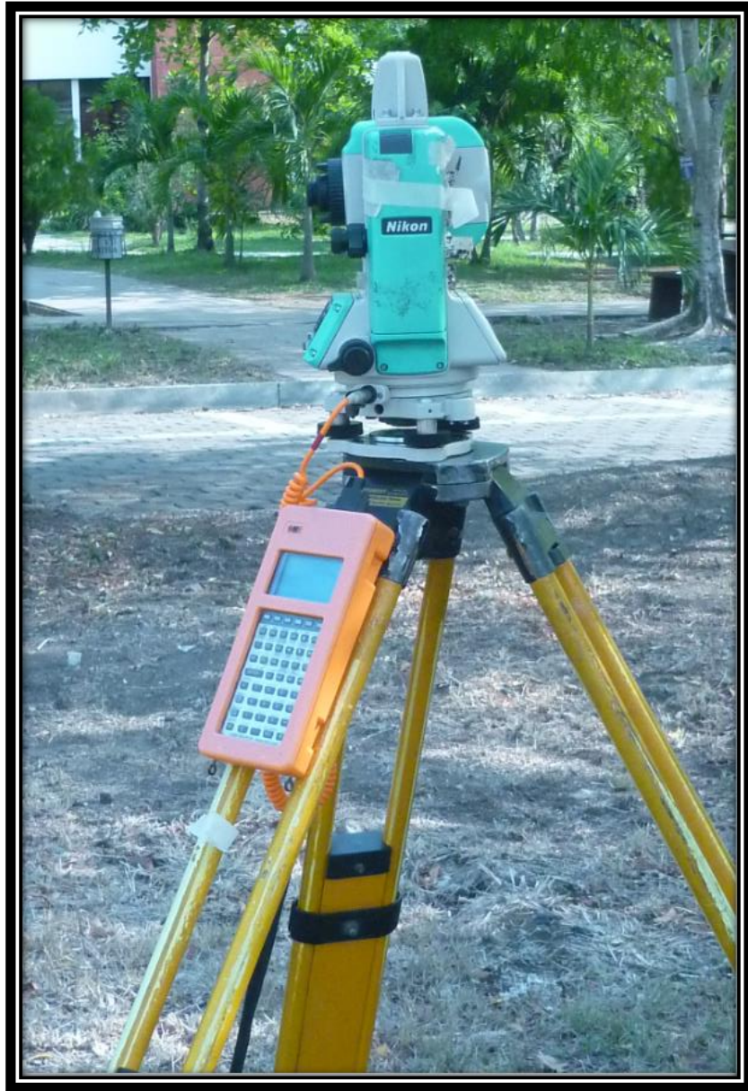
Figura 2.105 Colector y Estación Conectados
