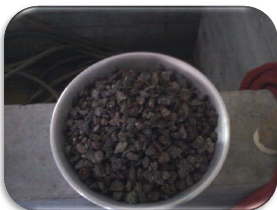
Ilustración 75 Fig3.13 a y b Secado al Horno de la Muestra
