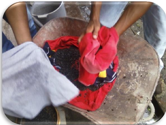
Ilustración 72 Fig. 3.10 24 horas después de su saturación la muestra fue secada superficialmente quedando saturados sus poros.
