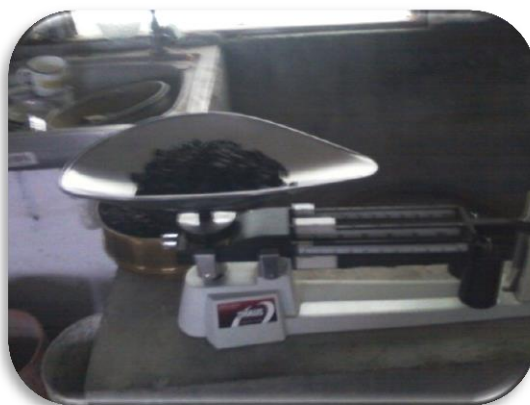
Ilustración 73 Fig. 3.11 Peso de la Muestra Saturado
