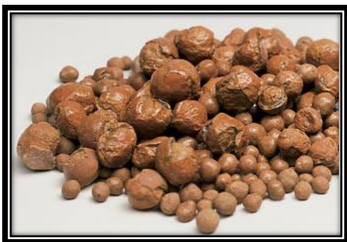
Ilustración 30 Fig. 2.30 Arcilla Expansiva
