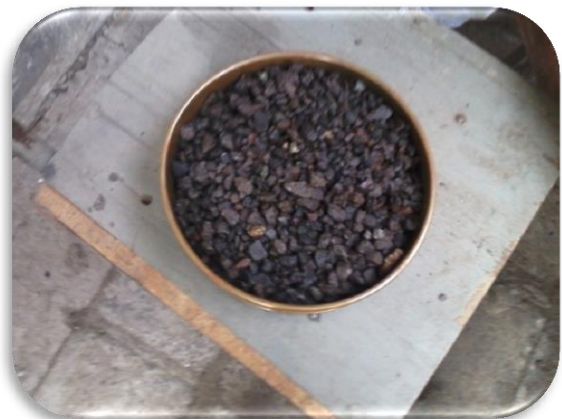
Ilustración 72 Fig. 3.10 24 horas después de su saturación la muestra fue secada superficialmente quedando saturados sus poros.
