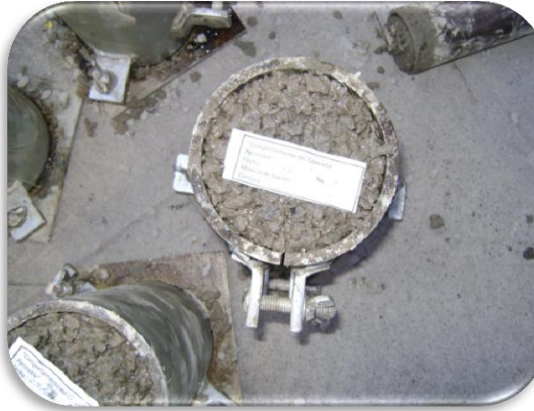
Ilustración 86 Fig. 3.19 Muestras de Especímenes Cilíndricos de la Cantera El Carmen a 15% de Vacíos
