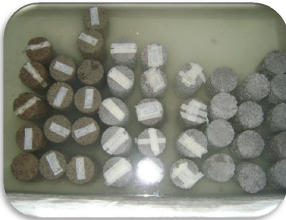
Ilustración 87 Fig. 3.21 Curado de Cilindros de Concreto
