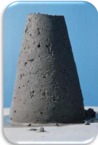
Ilustración Fig. 2 10 Concreto con bajo Revenimiento
