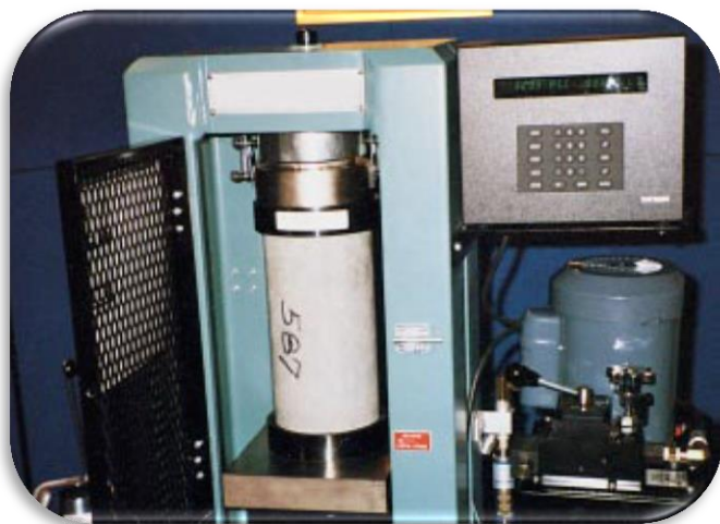
Fig. 2.17. Ensayo a compresión de cilindro de concreto de 150 x 300-mm (6 x 12-pulg.). La carga en el ensayo es registrada en la carátula
