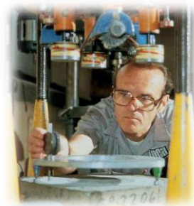
Ilustración 20 Fig. 2.20 Aparato de prueba para medir la resistencia a abrasión del concreto. La máquina se puede ajustar para el uso de ambos discos o ruedas de afilar. En una máquina diferente, las pelotas de acero bajo presión se ruedan encima de la superficie de la probeta. Los ensayos se describen en la ASTM C 779.
