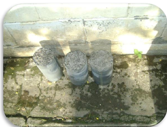
Ilustración 93 Cilindros elaborados con tubo de PVC para prueba de infiltración.
