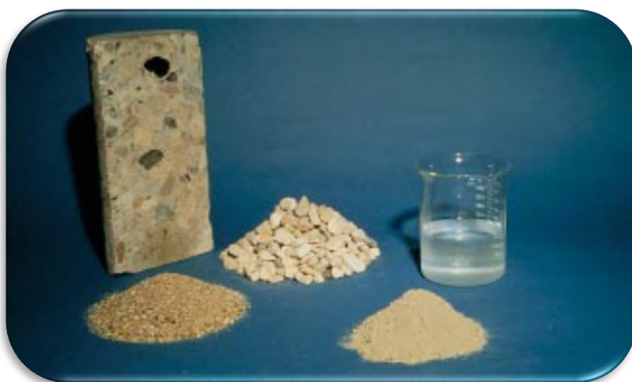
Fig. 2.1. Componentes del concreto: cemento, agua, agregado fino, agregado grueso, son combinados para formar el concreto.
