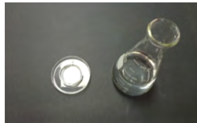
Figura 5. Forma como se colocan las cajas petri para poder agregar la solución de Nitrato de Plata, en la caja pequeña.
