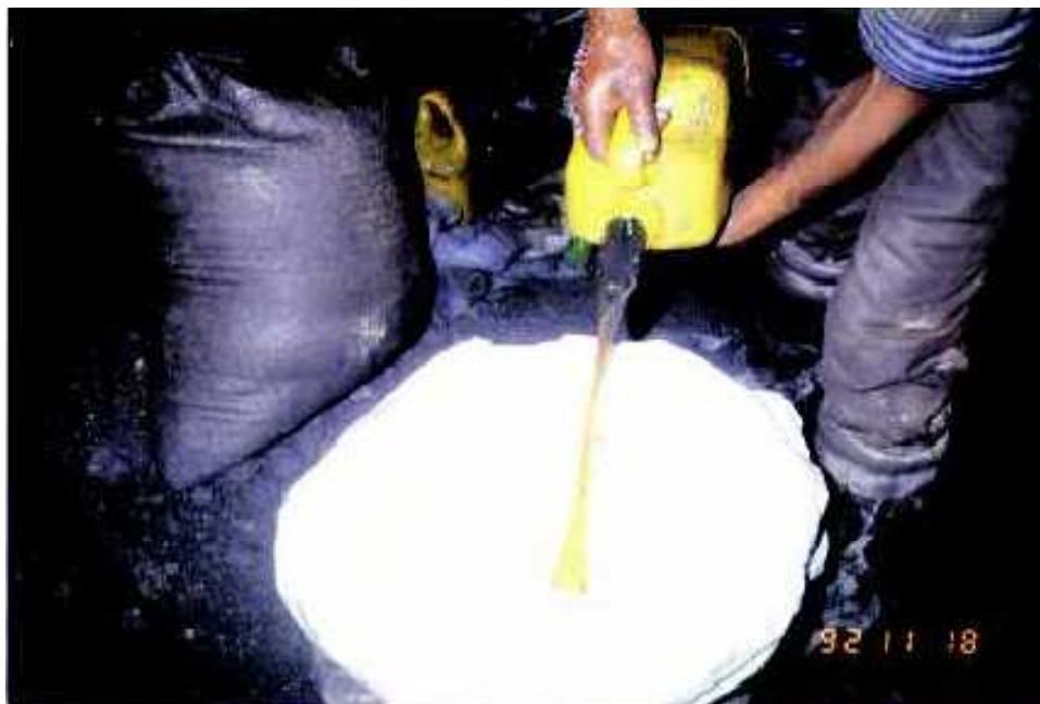
Fig.3.17 Vaciado de diesel al nitrato de amonio
