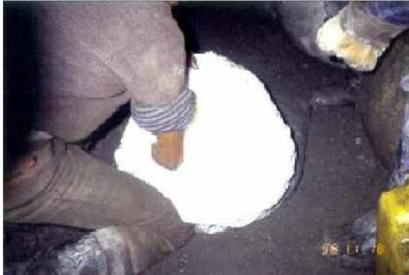
Fig. 3.18 Mezcla de nitrato de amonio y diesel
