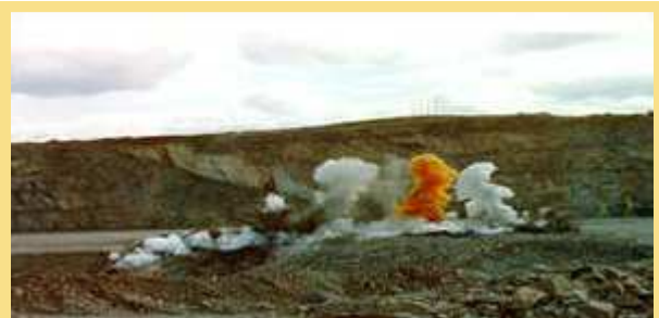
figura3.4 Problemas de vapores (humos rojos) que indican posible deterioro del explosivo.
