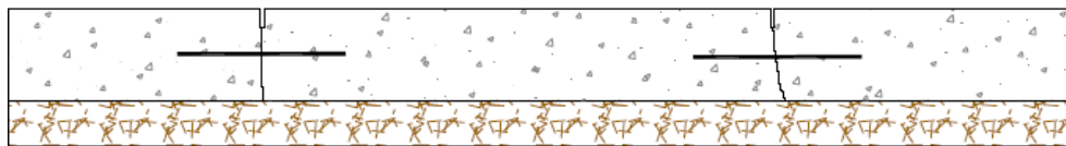
Figura 2.5 Sección longitudinal de un JPCP.
