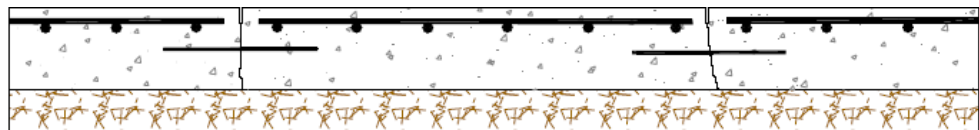
Figura 2.6 Sección longitudinal de un JRCP.
