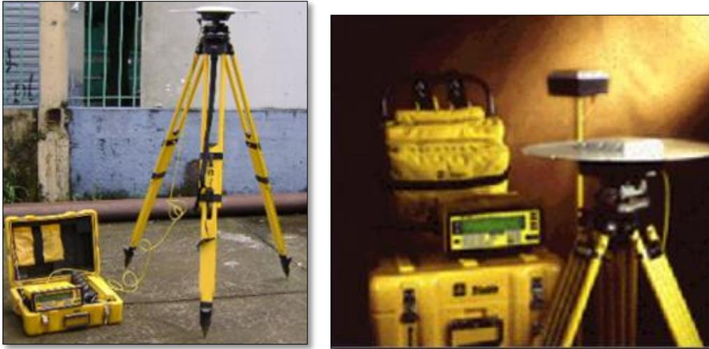
**Figura 3.11 Receptores Geodésicos de doble frecuencia.**
