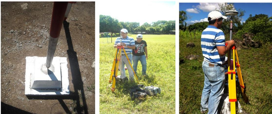
**Figura 6.18 Colocación y centrado de la antena.**
