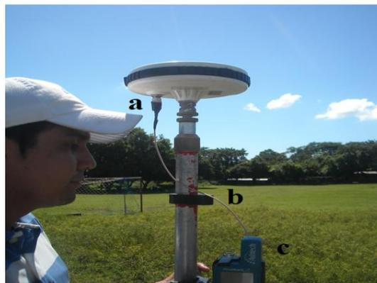
Figura 6.21 a-Conexión del cable a la antena, b- Nivel esférico del bastón y c- Conexión al receptor.
