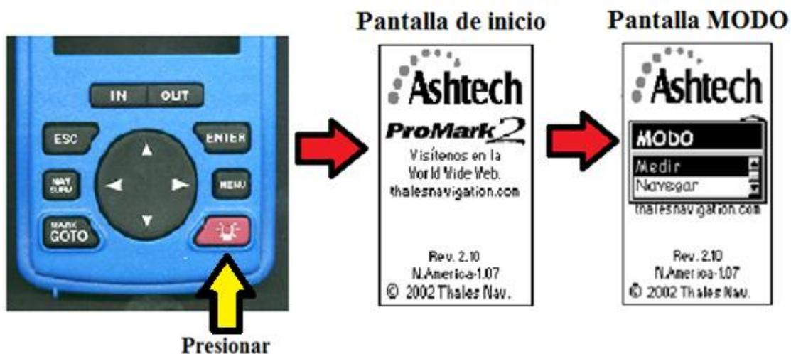
Automáticamente aparecerá destacada en la pantalla MODO, la opción MEDIR, la cual se seleccionará presionando el botón ENTER, entonces aparecerá la pantalla MEDIR.
