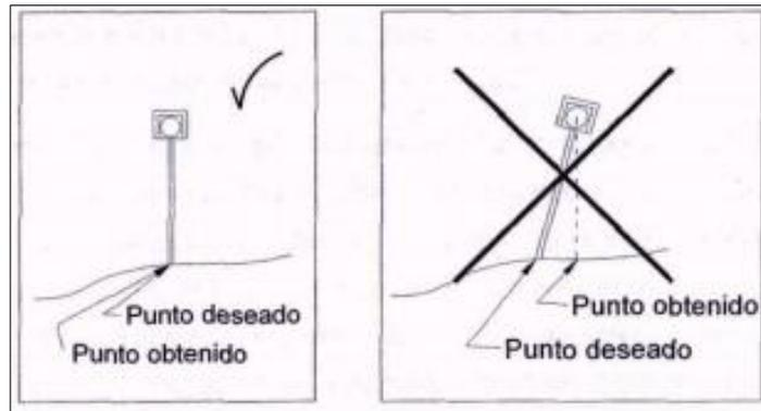
**Figura 5.21 Verticalidad del Prisma**
