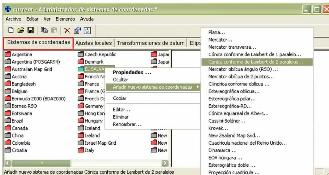
**Figura 6.91 Configuración del Sistema de Coordenadas.**
