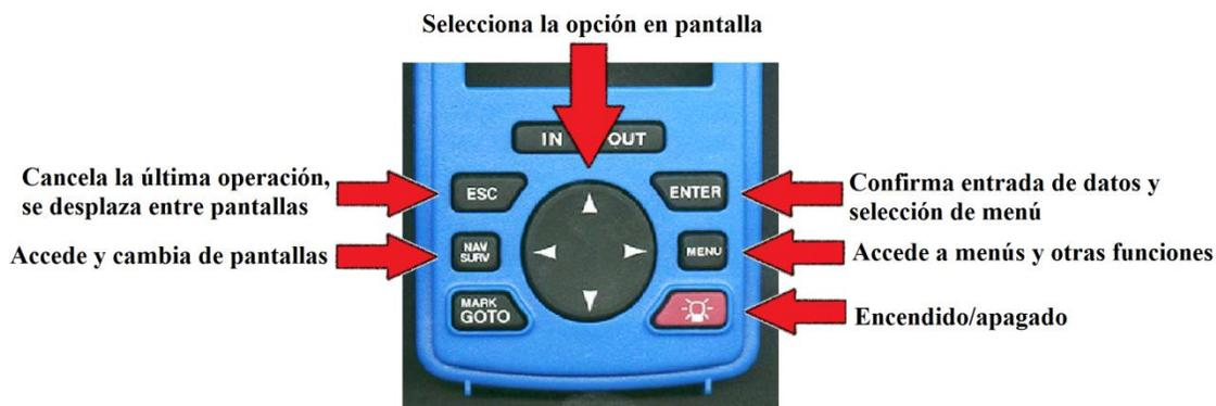
**Figura 6.25 Botones de control operacional para las funciones de medición del receptor del sistema Promark2.**
