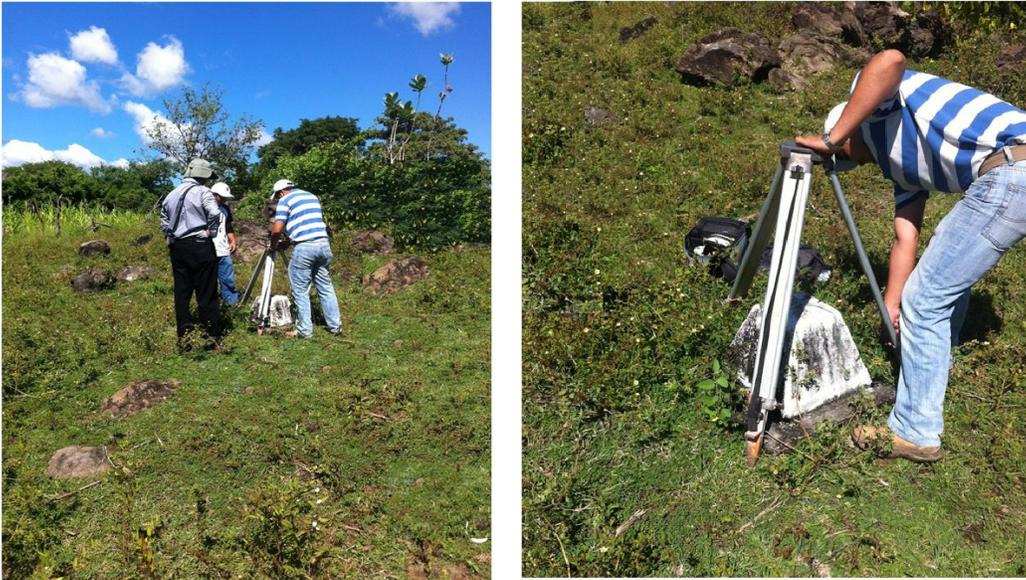
**Figura 6.17 Colocación del Trípode**
