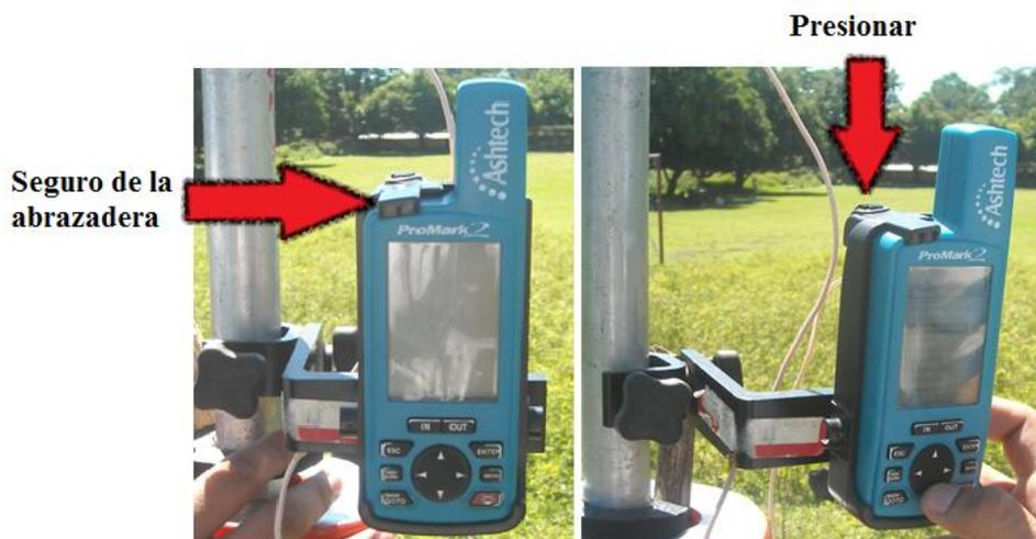
**Figura 6 19 Colocación del receptor en la abrazadera de campo**
