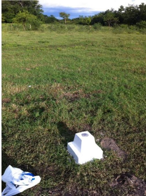
**Figura 6.8 Mojón Geodésico tipo III modificado.**
