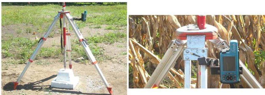
**Figura 6 20 Colocación de la abrazadera y receptor en el trípode**
