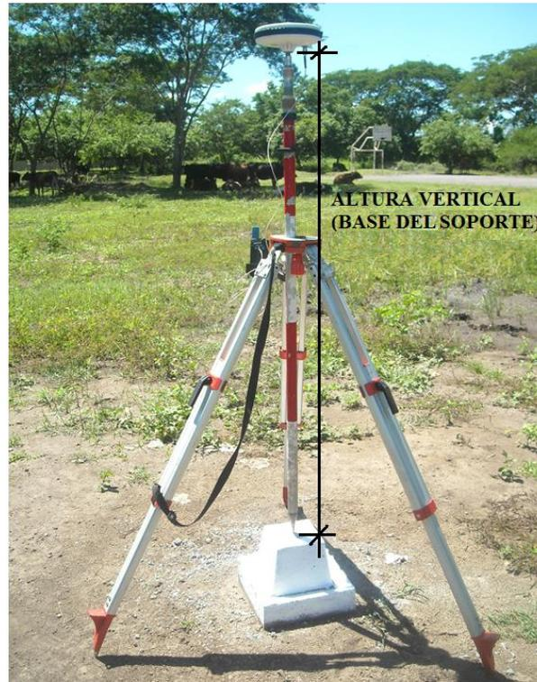
b) ALTURA ANTENA: Permite ingresar la altura de antena. El valor que aparece por defecto es 0.000.
